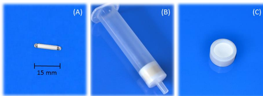
Fig 2. Fotos a escala de técnicas de extracción en fase sólida, (A) SBSE, (B) SPE, (C) RDSE.
