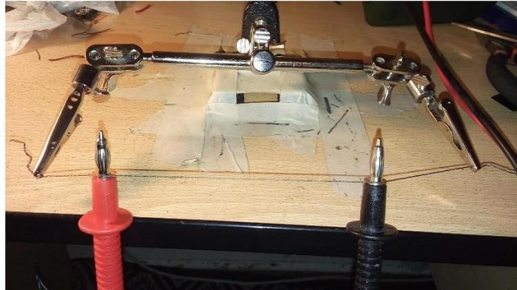
Figura 46: Prueba de resistencia del hilo conductor.
