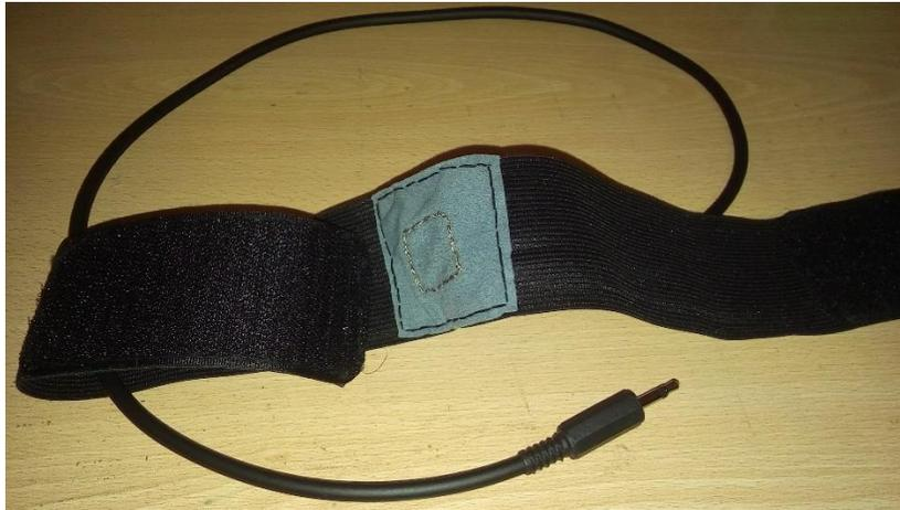
*Figura 48: Electrodo diseñado. Se aprecia el velcro, el electrodo PEDOT:PSS y el conector de 3.5 mm.*
