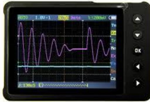
Figura 31: Osciloscopio DSO Nano V3.
