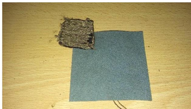
Figura 47: En la parte superior se ve la simulación de tela conductora, y debajo de ésta se encuentra el electrodo PEDOT:PSS.
