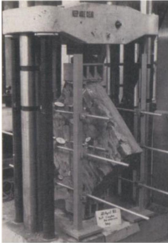
**FIGURA 2.7 Panel D1 instrumentado y cargado sobre su diagonal**
