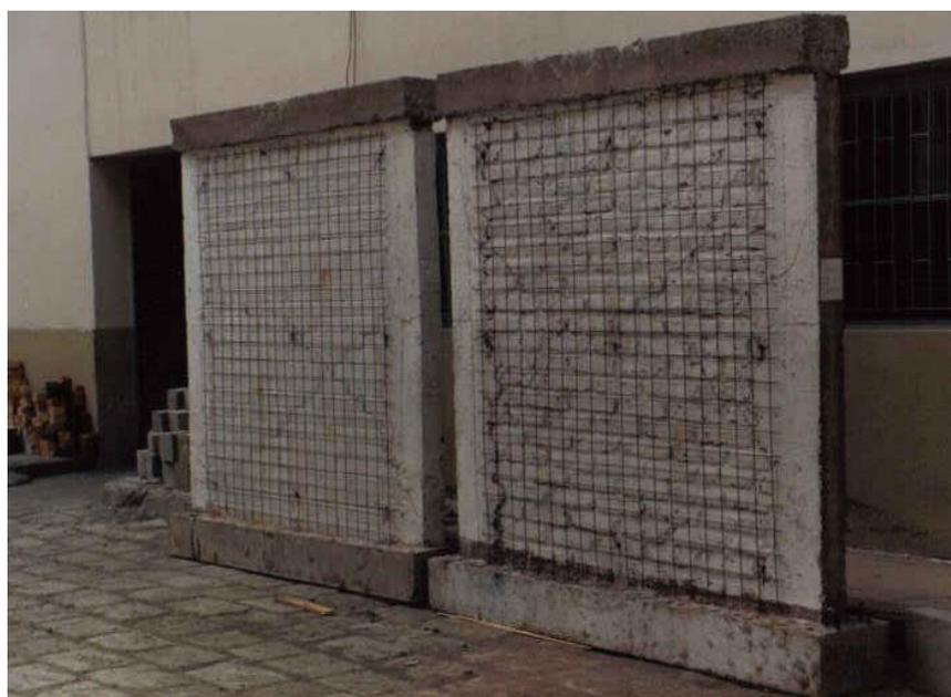
**FOTO 4.2 Muros Antes de la Reparación**
