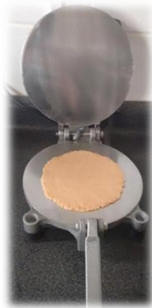
**Figura 2:** Prensado en caliente realizado en máquina tortilladora.
