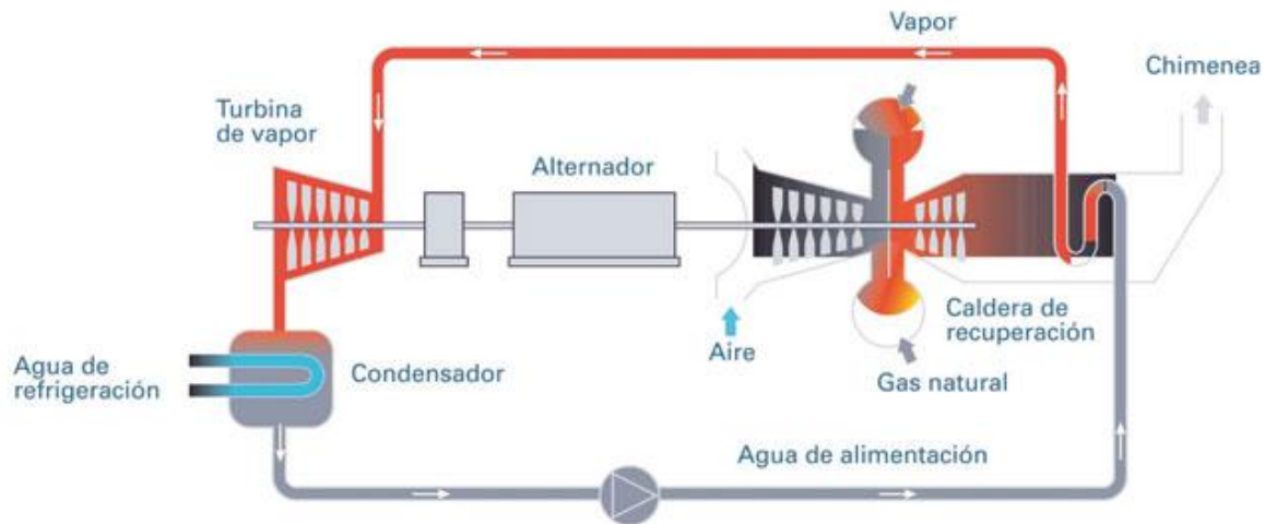
Figura 1-2: Ciclo agua - vapor en central térmica
