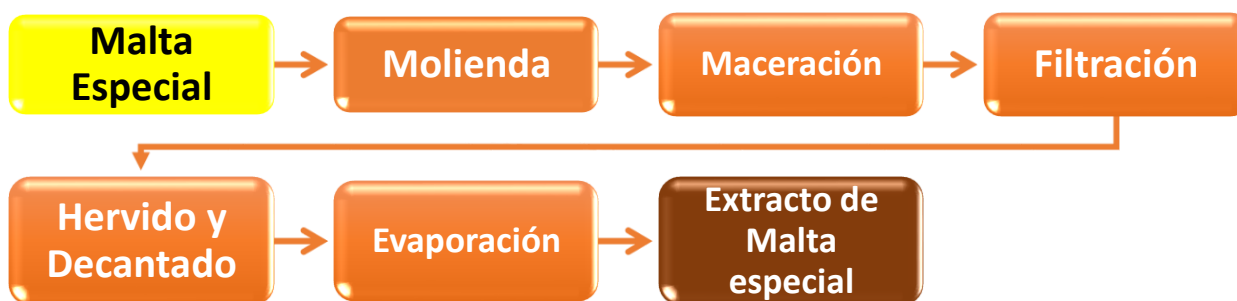
Figura 3 Diagrama de bloques del proceso del extracto de malta.
