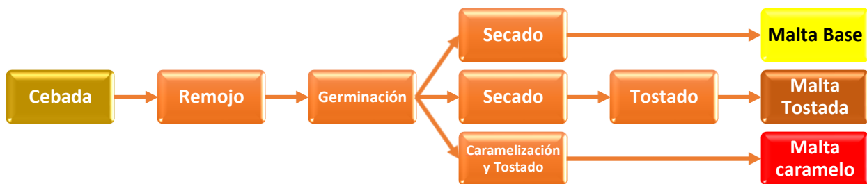
Figura 2 Diagrama de bloque de la producción de maltas base y maltas especiales.
