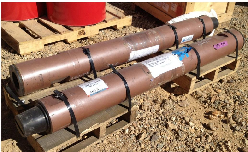
**Figura N°.20:** Adaptadores Superiores de 67" de largo.
