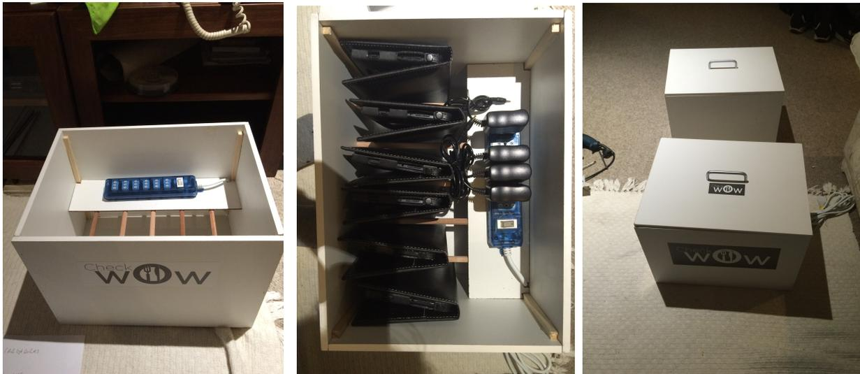
Como podemos ver en la imagen anterior, la estación de carga está compuesta por una caja con separadores y tapa, una zapatilla y los cargadores de los equipos.
