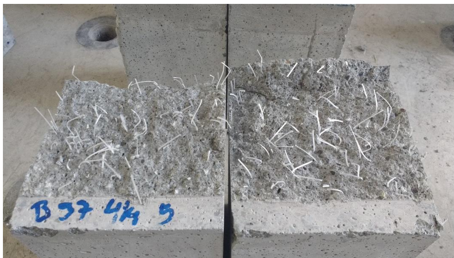
Figura 29. Distribución de fibras tipo hormigón H-B57-4.
