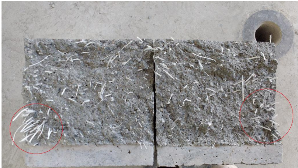
Figura 27. Distribución de fibras probeta n° 2 hormigón H-B48.
