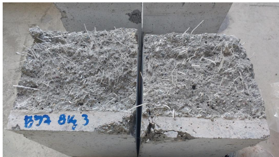
Figura 31. Distribución de fibras tipo hormigón H-B57-8.
