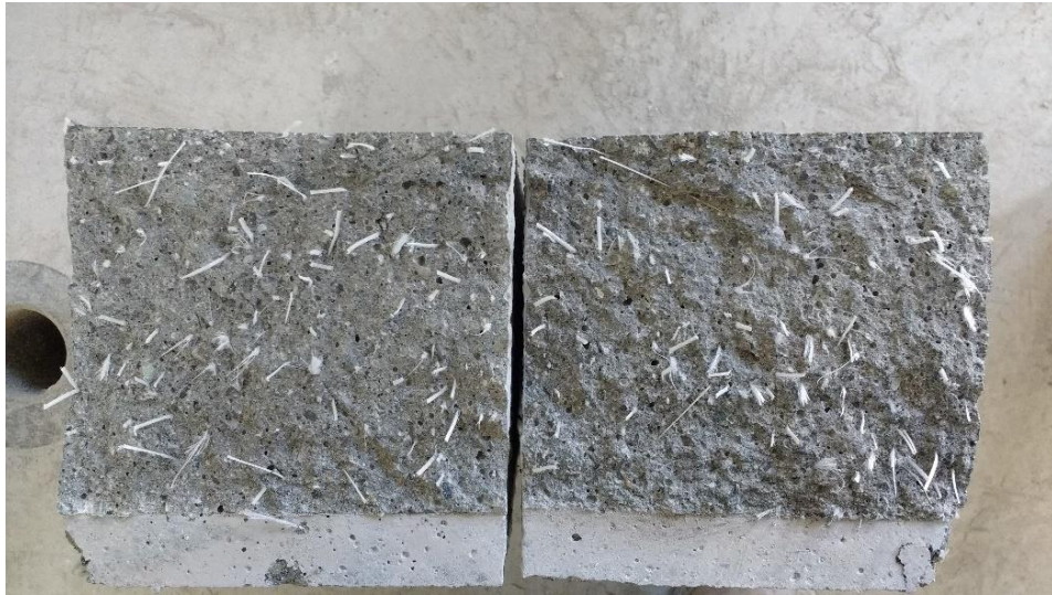
Figura 26. Distribución de fibras tipo hormigón H-B48-6.
