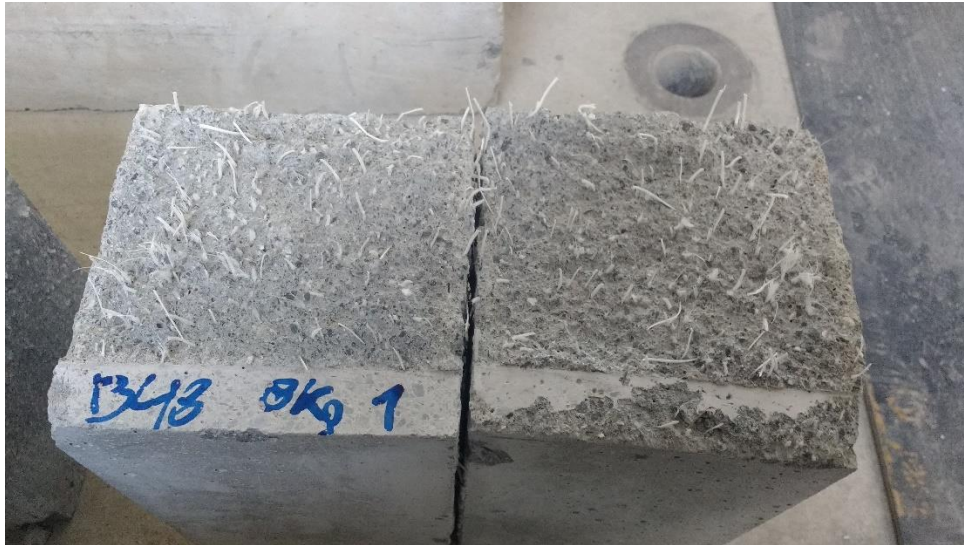
Figura 28. Distribución de fibras tipo hormigón H-B48-8.
