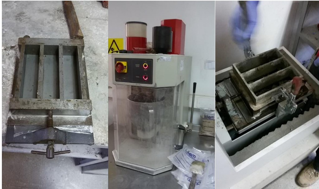
Figura 13 "Moldes y máquina de mezcla para confección de morteros"
