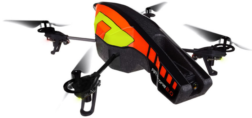
Figura 2: AR.Drone 2.0 carcasa para vuelos en el exterior
