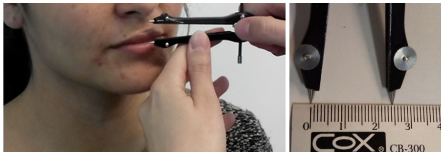
Imagen 8. Ejemplificación de medición directa empleando compás de punta seca y regla milimetrada.
