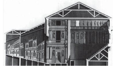
Teatro Olímpico de Vicenza, Italia. Perfil donde se observa la inclinación del escenario para mejorar perspectiva. Fuente: http://www3.northern.edu/wild/th100/chapt13a.htm
