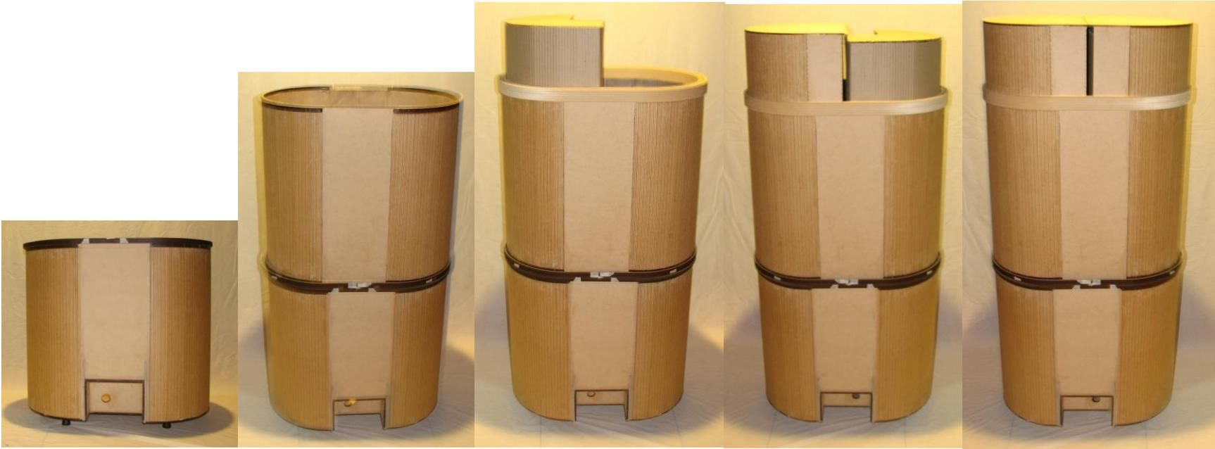
*Fig. 45 Armado del estaque en MDF. Fuente elaboración propia.*
