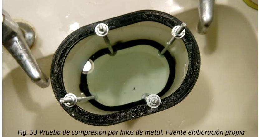
Fig. 53 Prueba de compresión por hilos de metal. Fuente elaboración propia
