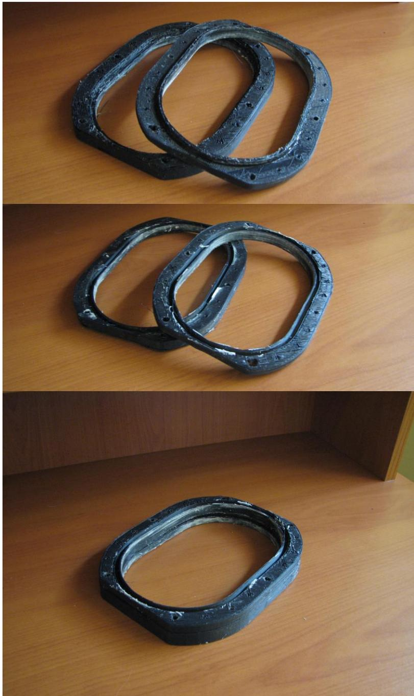
*Fig 48 Cinturón media H con aleta exterior. Fuente elaboración propia*
