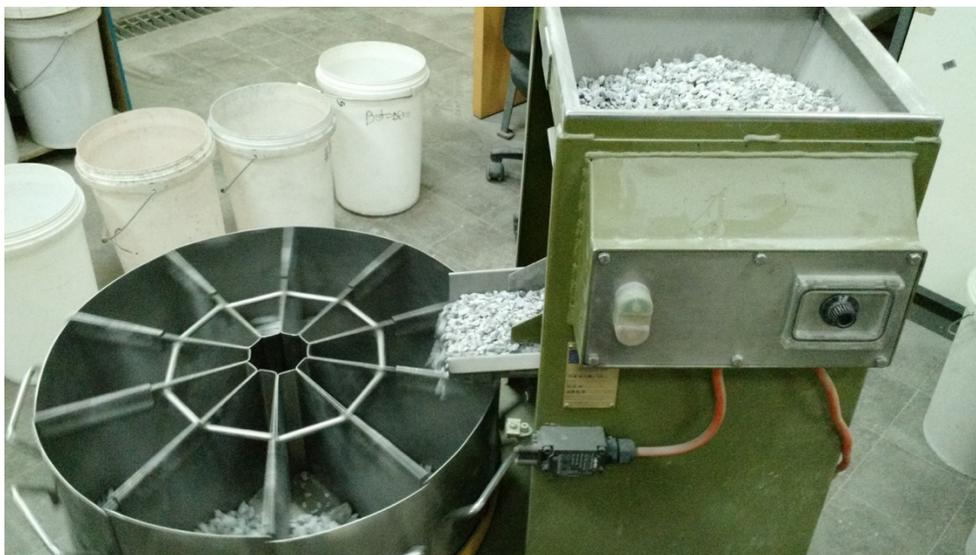
*Figura 72: Cortador rotatorio*
