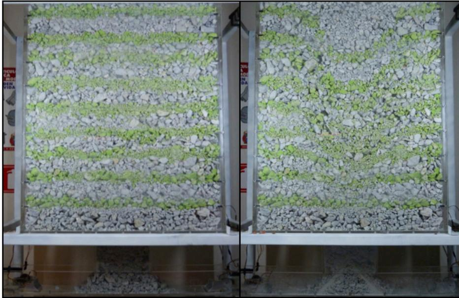
*Figura 74: Flujo experimento 1 (inicio y 500 extracciones)*
