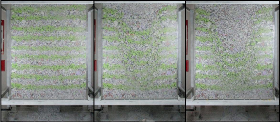
*Figura 77: Flujo experimento 4 (inicio, 500 y 800 extracciones)*
