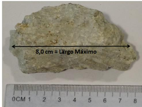
Figura 68: Medida del largo máximo de un fragmento
