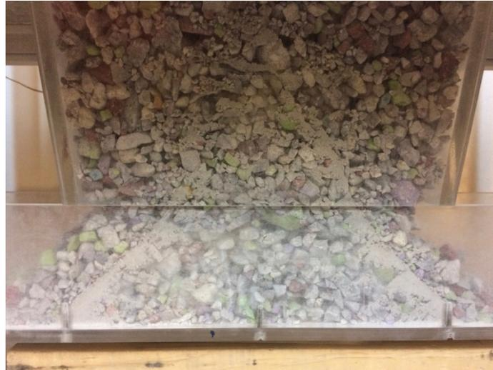
*Figura 80: Perfil elipsoide de flujo visto desde la batea, experimento 6*
