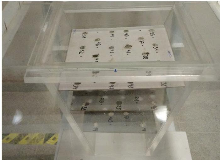
Figura 50: Disposición de marcadores en batea corta, malla 16x15
