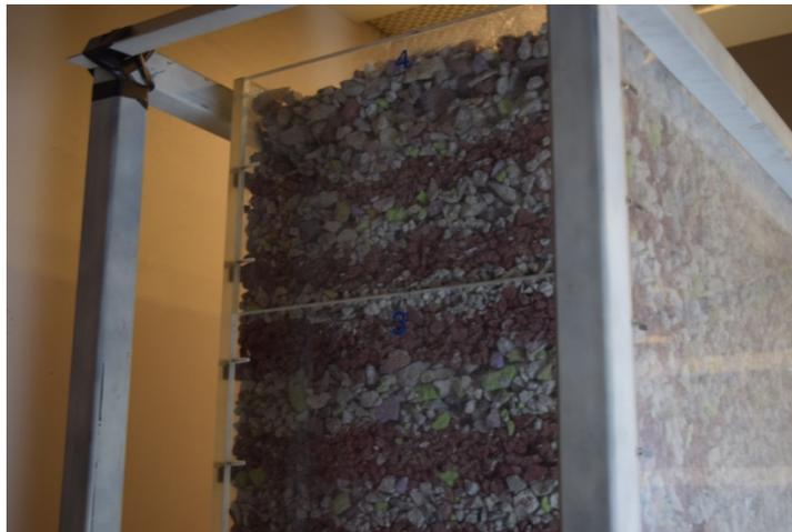
*Figura 81; Interacción elipsoide de flujo con pared lateral, experimento 6 1250 extracciones*
