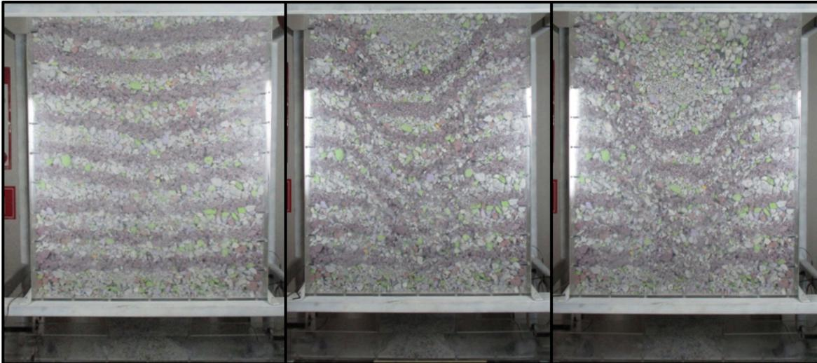
*Figura 78: Flujo experimento 5 (inicio, 500 y 700 extracciones)*
