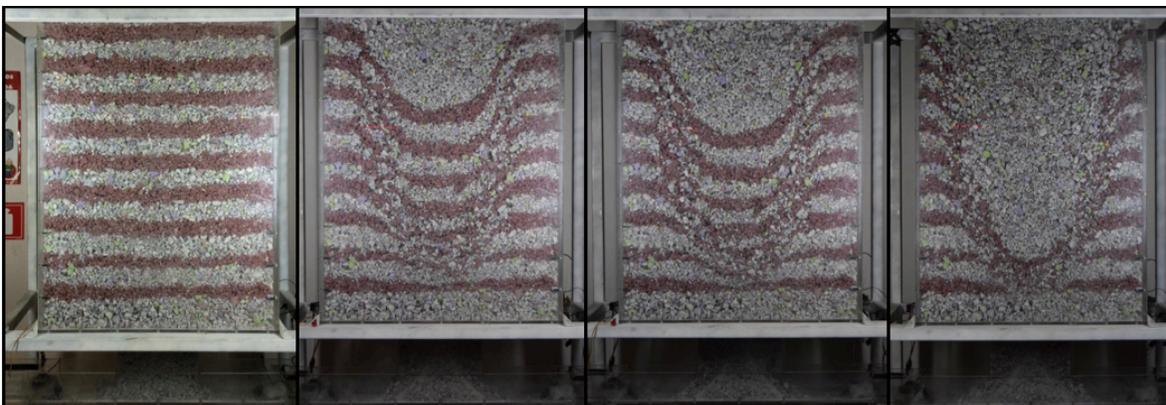
*Figura 79: Flujo experimento 6 (inicio, 500, 800 y 1250 extracciones)*
