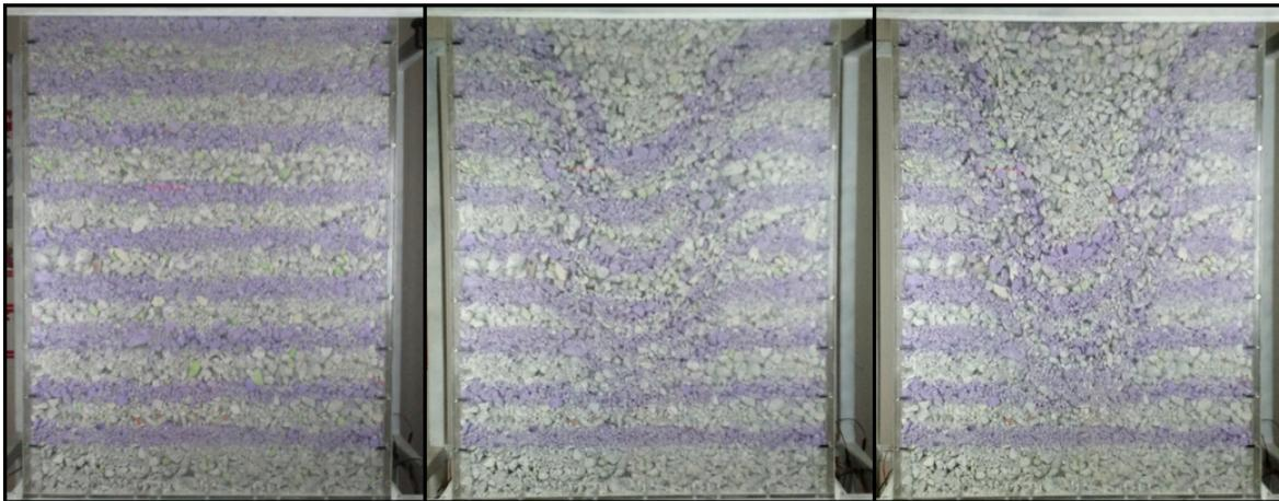
*Figura 75: Flujo experimento 2 (inicio, 500 y 800 extracciones)*
