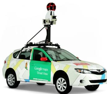
Figura 2.4: Automóvil con cámara incorporada para capturar imágenes posteriormente utilizadas en Street View [goo, 2016b].
