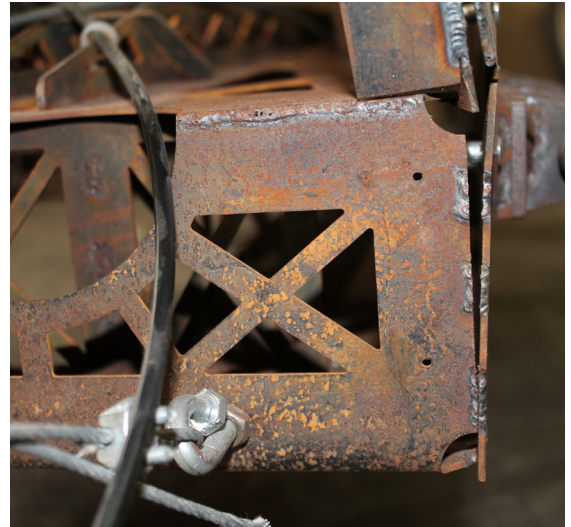
Imagen 65. Grieta derecha plataforma base. Fuente: Elaboración propia.
