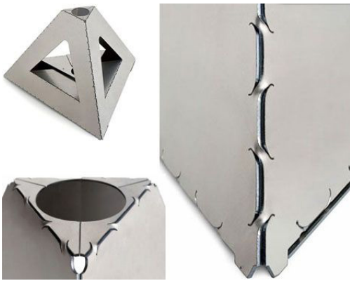
Imagen 22. Origami Industrial. Fuente: http://dornob.com/metal-origami-flat-pack-sheets-form-super-strong-shapes/#ixzz2ZrLMeSaf&i (Dornob)
