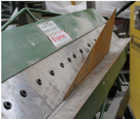
Imagen 57. Proceso de plegado de la plancha de acero. Fuente: Elaboración propia.
