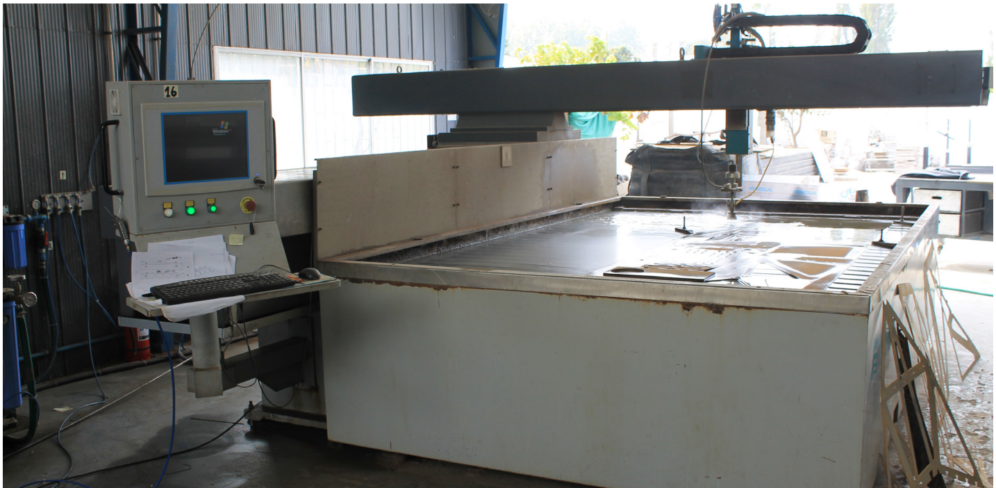
Imagen 37. Mecanizado hidrodinámico (corte por chorro de agua).
