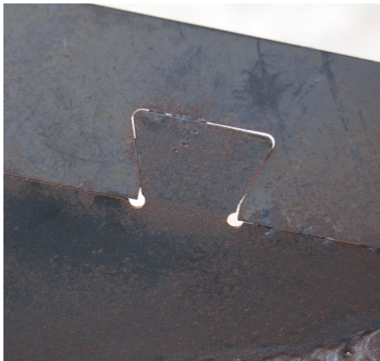
Imagen 66. Error de encastrados. Fuente: Elaboración propia.
