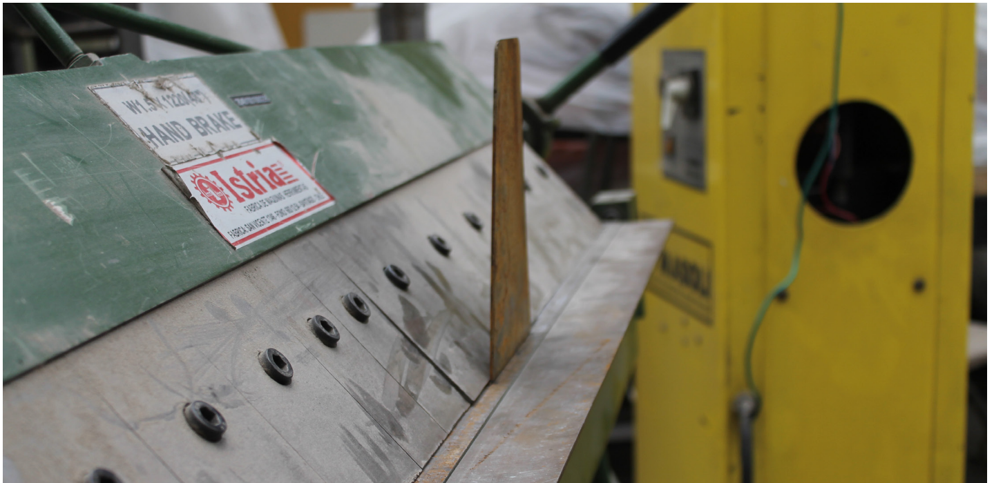
Imagen 35. Plegado de la plancha de acero. Fuente: Elaboración propia.
