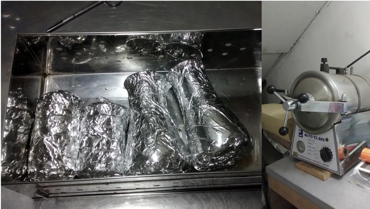
Imagen 25. Esterilización de instrumentos en autoclave de sobremesa. Elaboración propia.
