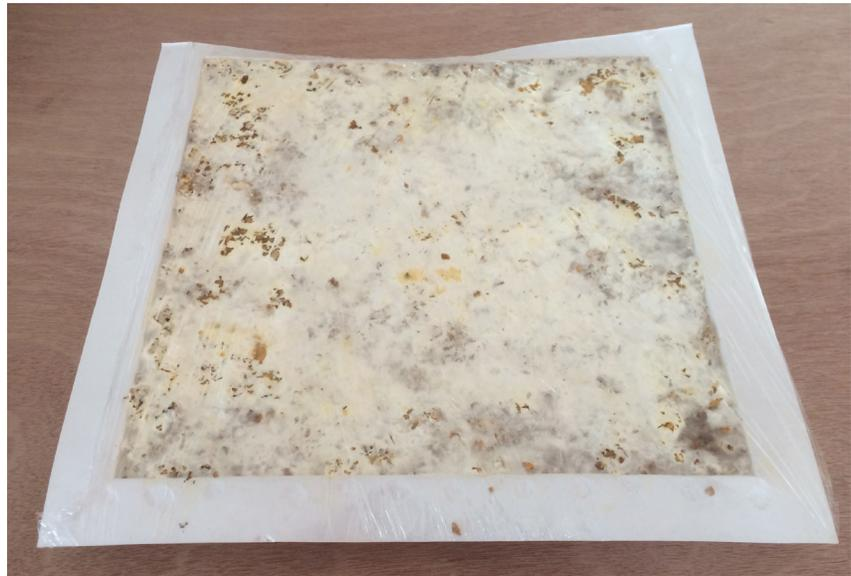
Imagen 63. Crecimiento del material micelio en molde de PAI. Elaboración propia.
