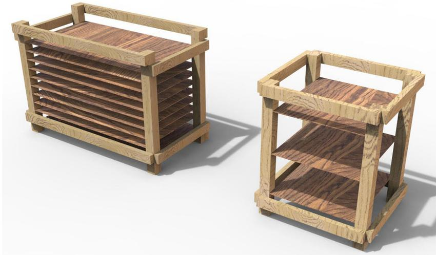
Imagen 43. Render de cámara húmeda para disponer de las muestras del material micelio. Elaboración propia.
