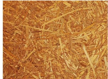
Imagen 1. Tablero fabricado en base a rastrojos de arroz, Kokoboard. Fuente materia.nl
