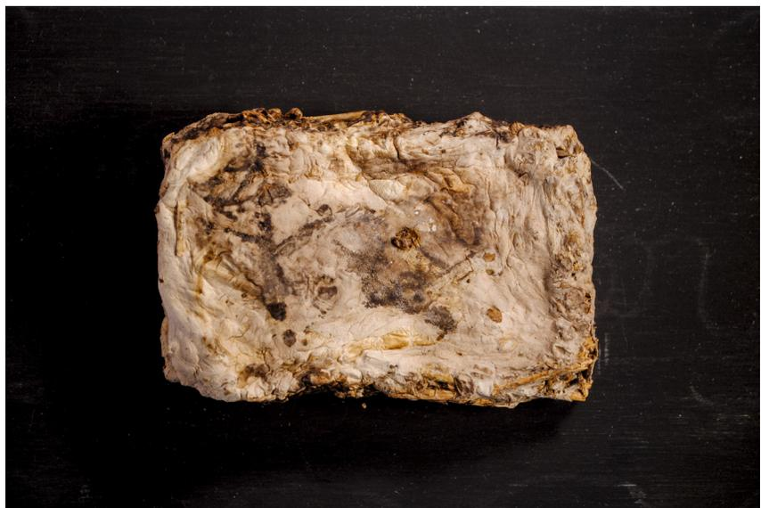
Imagen 39. Probeta de material micelio fabricada con rastrojos de alfalfa.
