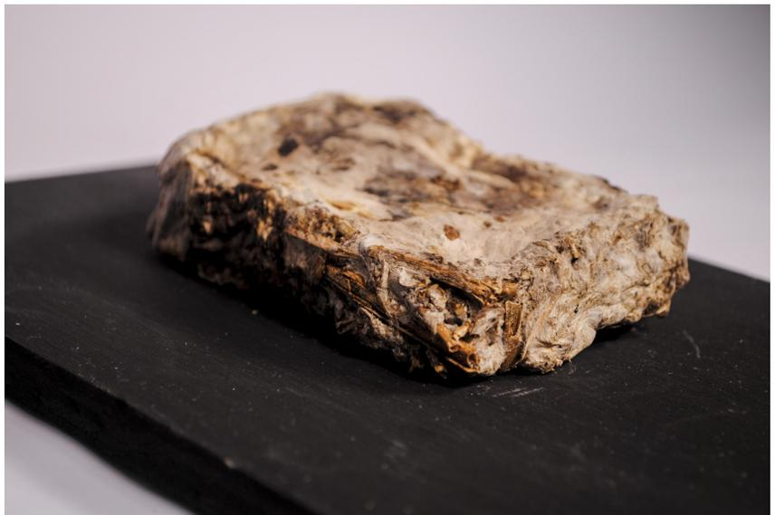
Imagen 37. Probeta de material micelio fabricada con rastrojos de alfalfa.
