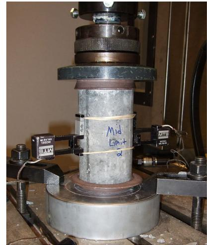
Imagen 47. Ensayo de compresión de una probeta cilíndrica de hormigón. Fuente wikimedia.org, License Public Domain
