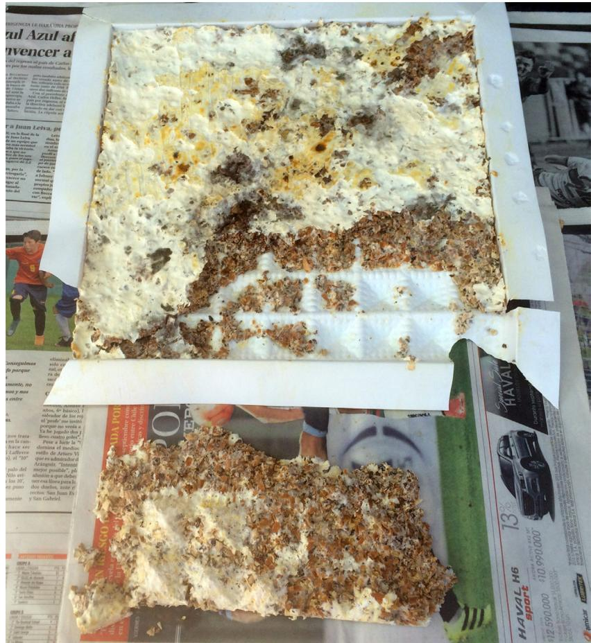
Imagen 69. Fractura de la pieza debido a la complejidad geométrica del molde.
