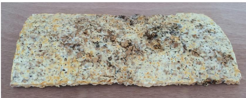
Abajo: Imagen 60. Curvatura simple fabricada con material micelio. Elaboración propia.
