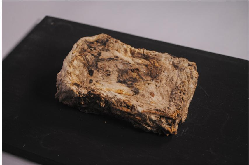
Imagen 38. Probeta de material micelio fabricada con rastrojos de alfalfa.
