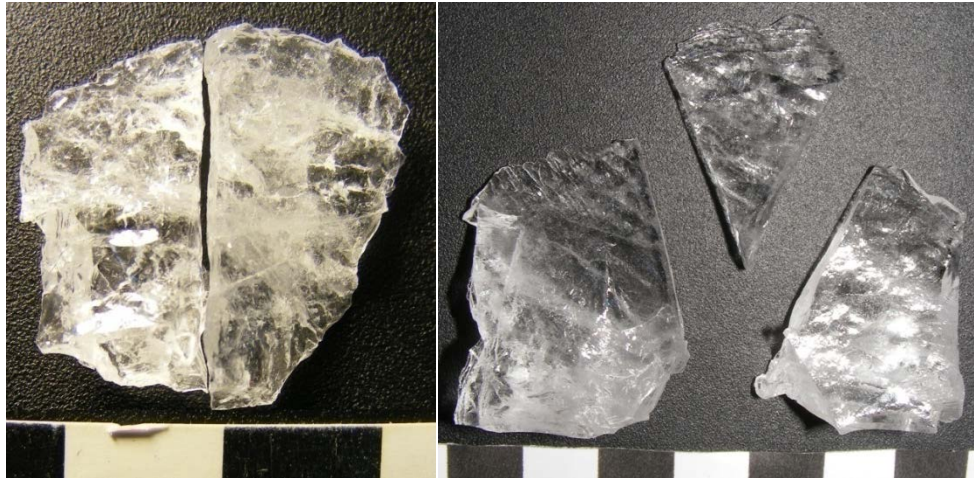
Figura 11. (Izq) Pieza con fractura longitudinal, Experimento N° 1. (Der) Pieza con fractura radial, Experimento N°3.
