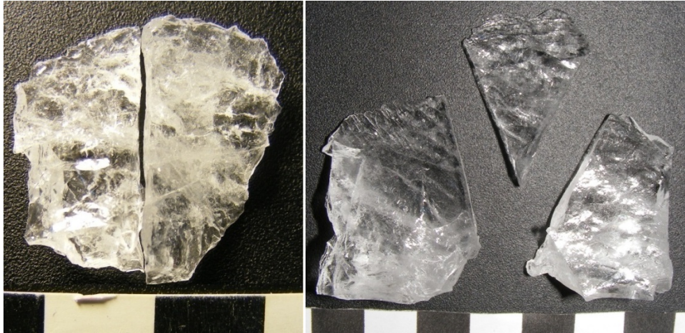
Figura 3. (Izquierda) Pieza con fractura longitudinal, Experimento N° 1. (Derecha) Pieza con fractura radial, Experimento N°3.
