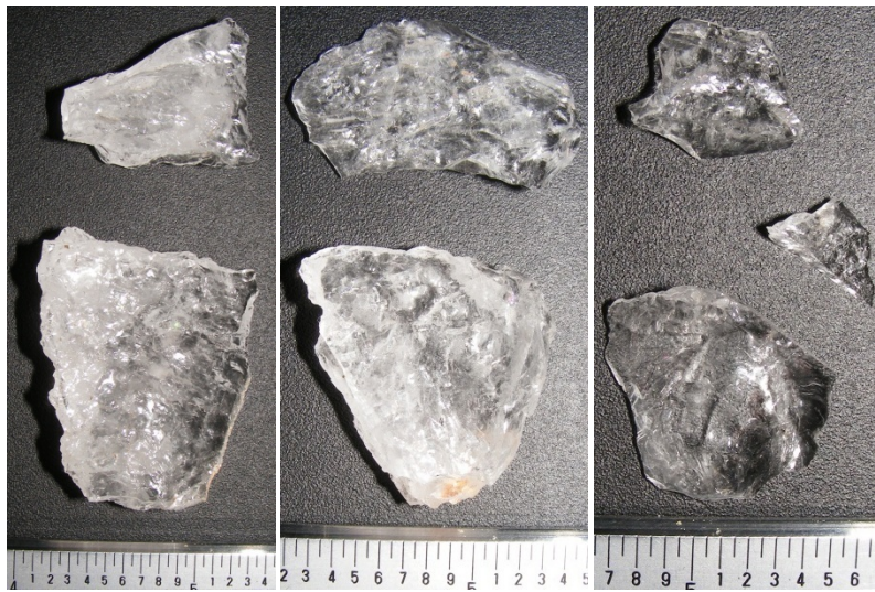
Figura 4. Experimento N° 1: (Izquierda y Centro) Piezas con fractura Transversal. (Derecha) Pieza con fractura transversal y diagonal.
