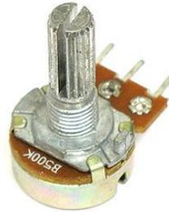
Figura 17: Potenciómetro B500K
