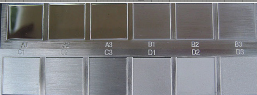
Imagen. Acabado de superficie Protomold. Superficie seleccionada: A3.
