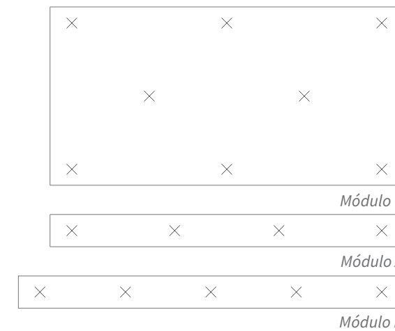
Ubicación de las ruedas en los 3 tipos de módulos. Vista en planta.
