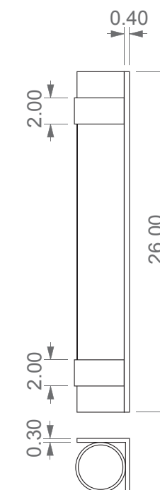
Planimetría de la pieza "módulo base". Vista frontal y superior, elaboración personal.
