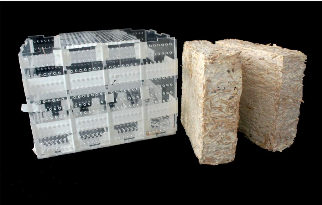
Imagen 100. Molde de acrílico y la figura resultante.
