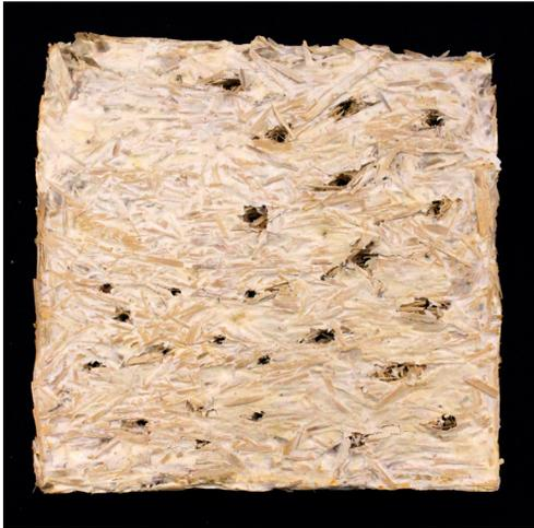
Imagen 63. Resultado del perforado mediante el taladro de pedestal. Fuente: Elaboración propia.
