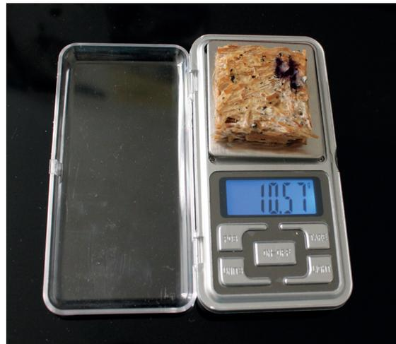
Imagen 76. Pesado de la pieza n°4 luego de 2+ 22hrs de sumersión. Fuente: Elaboración propia.
