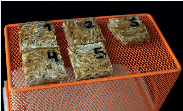
Imagen 73. Probetas escurriendo antes de ser pesadas.
