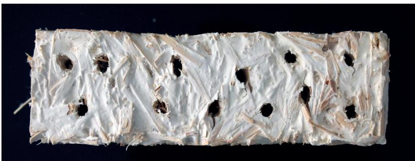
Imagen 65. Resultado del perforado utilizando dremel. Fuente: Elaboración propia.
