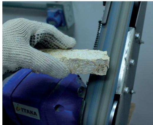
Imagen 58. Proceso de lijado utilizando esmeril. Fuente: Elaboración propia.
