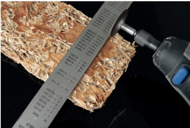
Imagen 53. Proceso de corte utilizando dremel.
