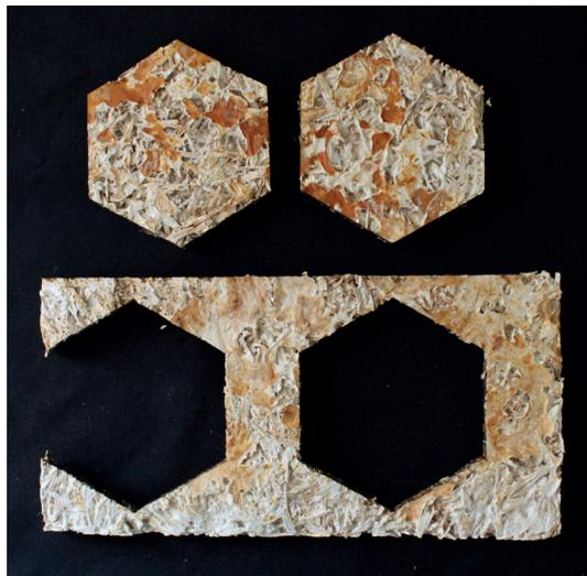
Imagen 55. Resultado del corte realizando con la máquina de corte laser.
