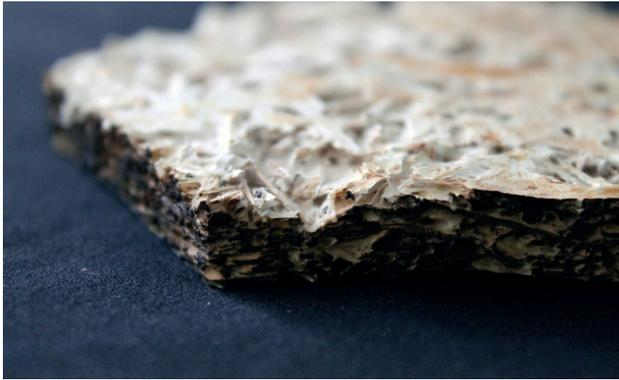
Imagen 56. Resultado de la terminación en el material utilizando corte laser. Fuente: Elaboración propia.
