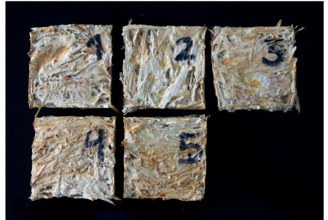
Imagen 70. Probetas para ensayo de Absorción de Agua. Fuente: Elaboración propia.
