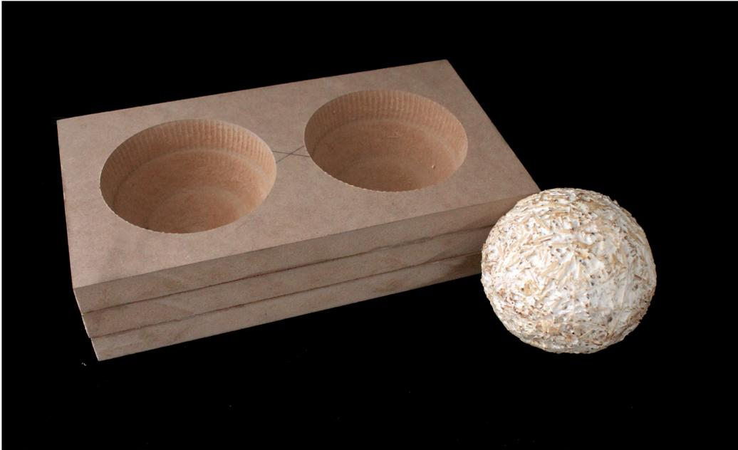
Imagen 101. Molde mdf y cnc y su figura resultante
