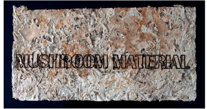
Imagen 57. Resultado del grabado realizado con la máquina de corte laser. Fuente: Elaboración propia.
