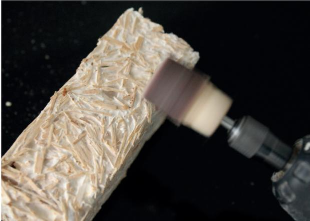
Imagen 60. Proceso de lijado utilizando dremel.
