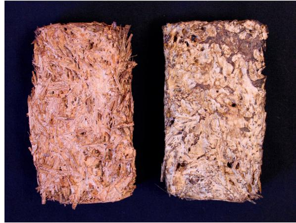
Imagen 68. Izquierda, probeta sin inhibición del hongo y a la derecha la probeta con inhibición del hongo.
