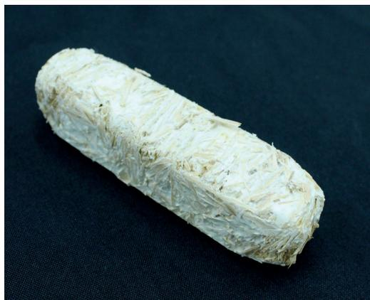
Imagen 59. Resultado del lijado utilizando esmeril. Fuente: Elaboración propia.
