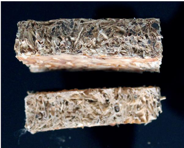
Imagen 54. Resultado del corte utilizando dremel.
