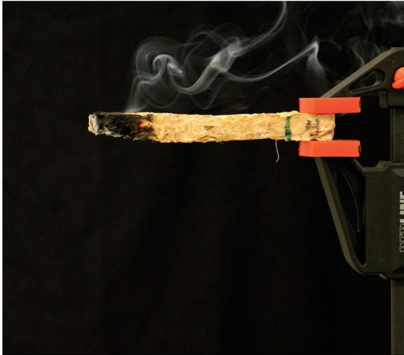
Imagen 84. Ensayo de la probeta n°4, momento en que la llama se apaga luego de retirar el fuego directo.
