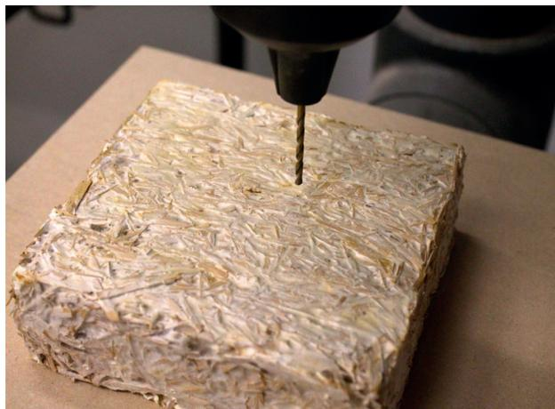
Imagen 62. Proceso de perforado utilizando el taladro de pedestal. Fuente: Elaboración propia.
