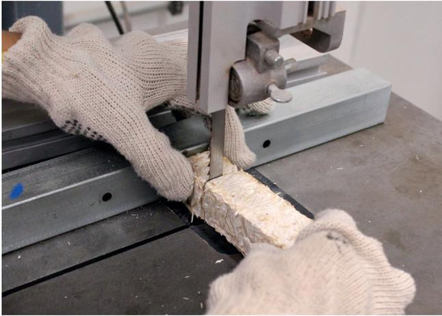
Imagen 51. Proceso de corte utilizando sierra de huincha.
