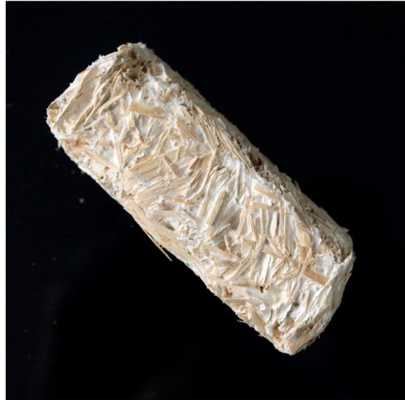
Imagen 61. Resultado del lijado utilizando dremel.
