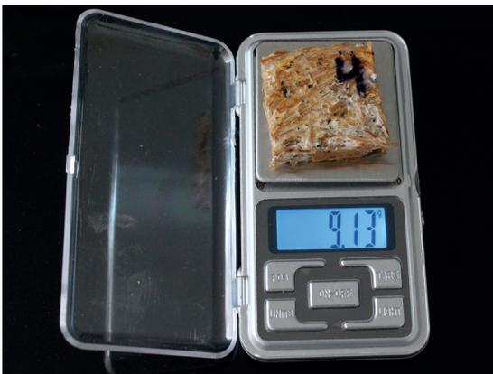
Imagen 74. Pesado de la pieza n°4 luego de 2 hrs de sumersión. Fuente: Elaboración propia.
