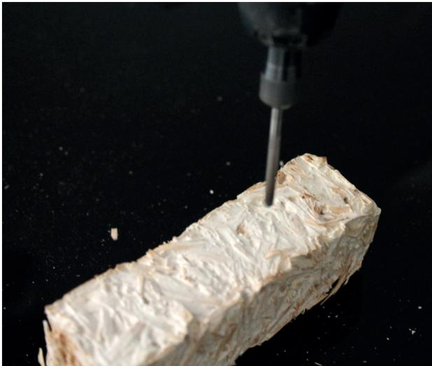
Imagen 64. Proceso de perforado utilizando dremel. Fuente: Elaboración propia
