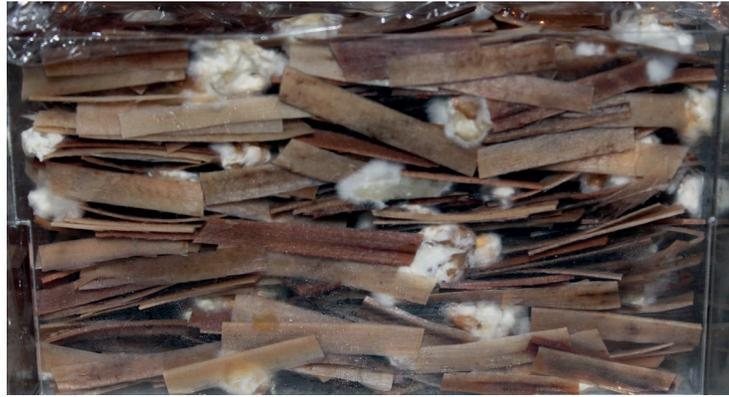
Imagen 44. Disposición del residuo de mimbre desmedulado en el molde de cultivo. Fuente: Elaboración propia.
