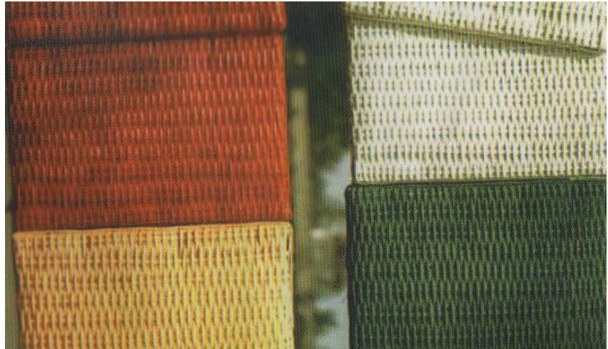
Fotografía de ensayos de aplicación de pinturas, barniz y tintes. (INFOR, 1998)
