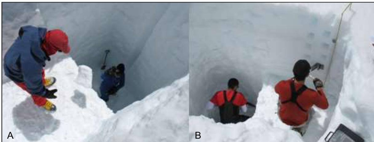
Figura 10. Cálculos de profundidad (A) y densidad (B) en pozo estratigráfico glaciar Echaurren Norte. (Fuente UGN-DGA).
