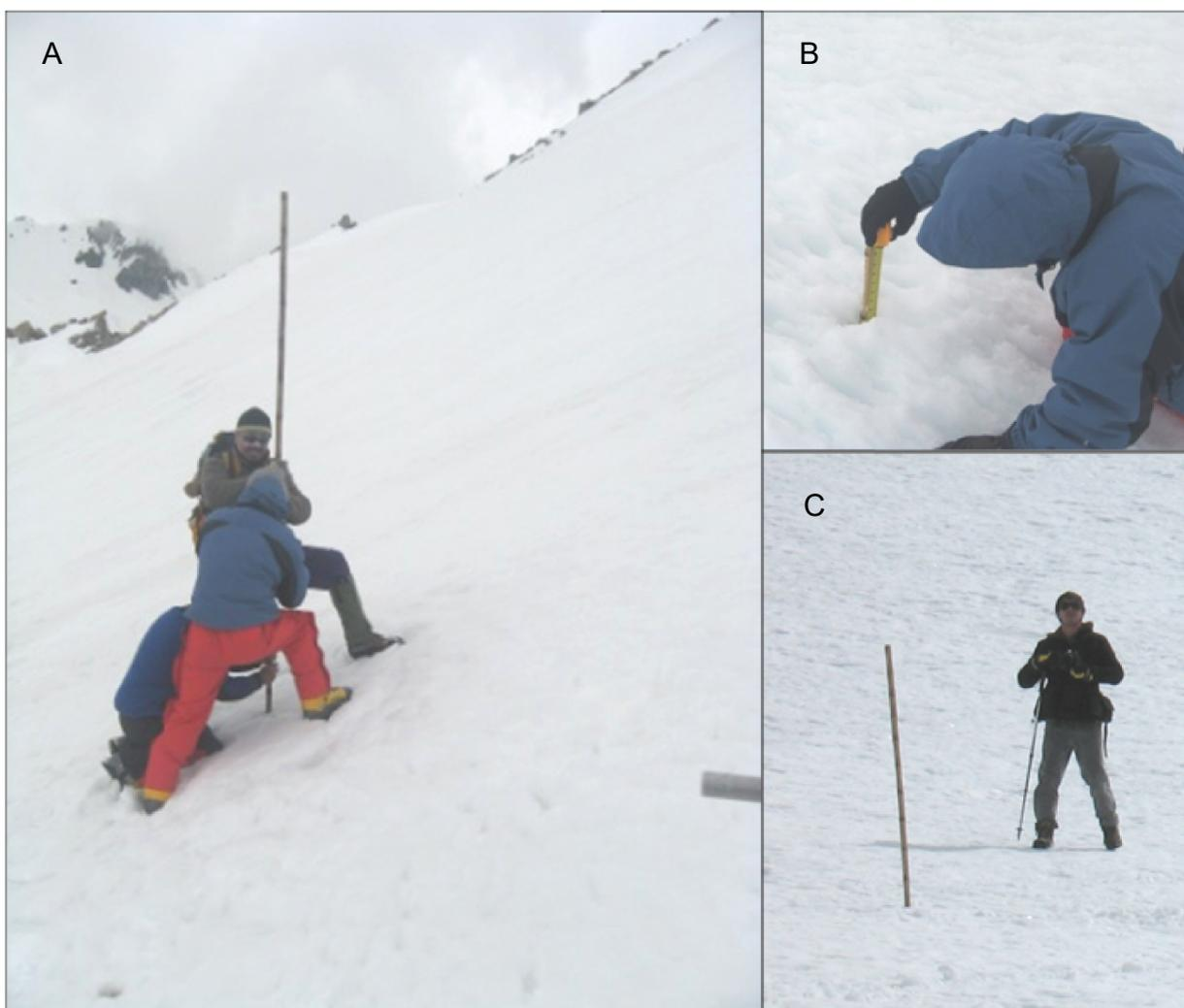
Figura 11. Instalación y medición de balizas en glaciar Echaurren Norte: (A) instalando/profundizando baliza; (B) midiendo baliza instalada/profundizada; (C) control de baliza para profundización. (Fuente: UGN-DGA)
