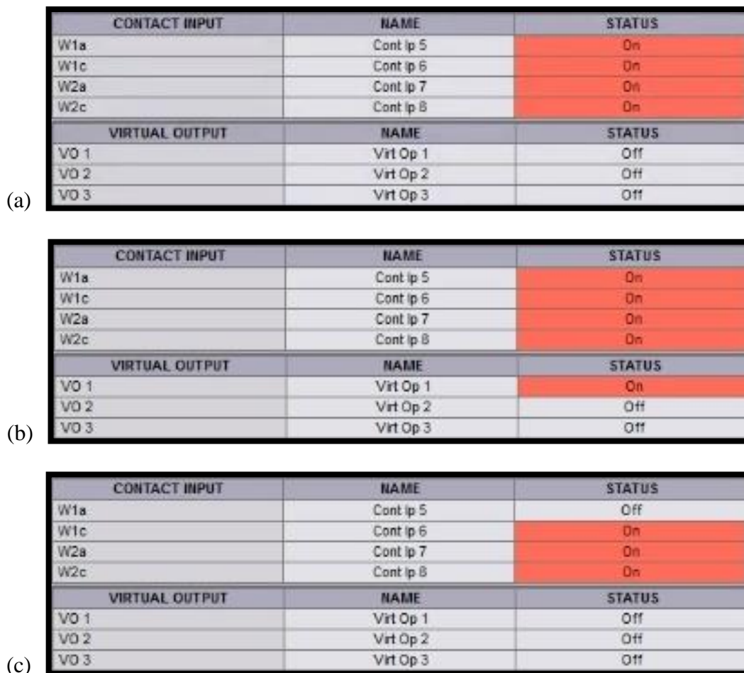
Figura 5.6. Valores de verdad de las funciones del F35 antes, durante y después de una anomalía.
