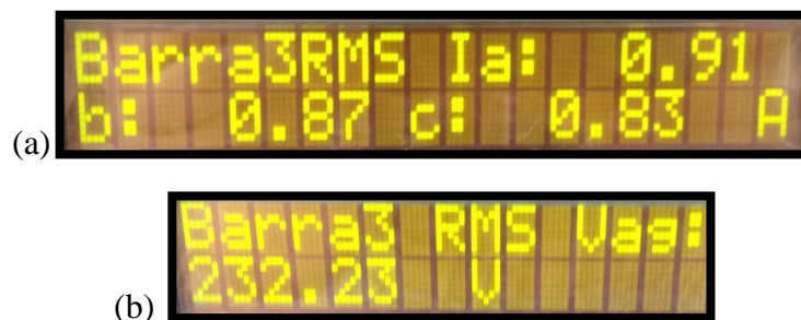
Figura 5.1. Valores de variables eléctricas a la entrada del F35, a través de su LHM I
