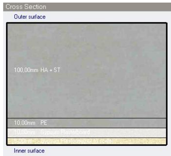
Ilustración 5.2.4.1: Perfil muro exterior.
