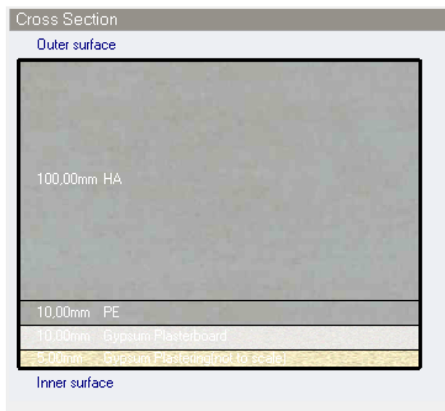
Ilustración 5.2.1: Perfil muro exterior.
