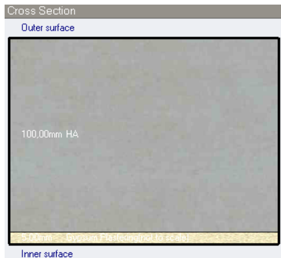
Ilustración 5.3.4.1: Perfil muro exterior.
