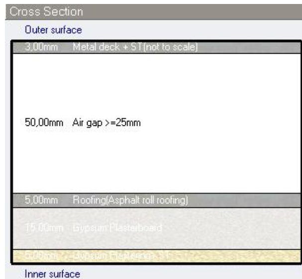
Ilustración 5.2.3.1.b: Perfil Techumbre.
