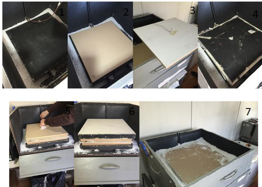
Ilustración 4.2.1.2: Montaje ensayo conductividad.
