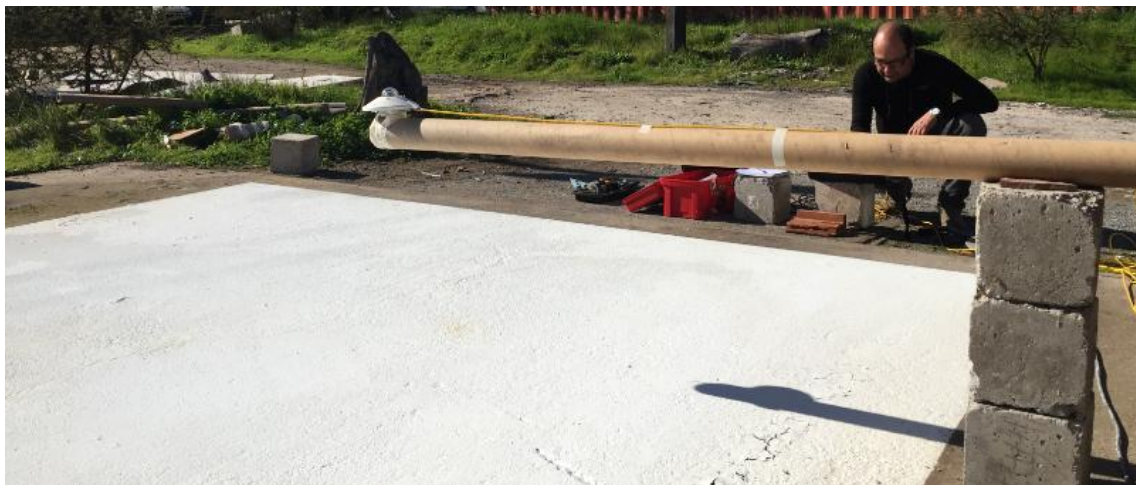
Ilustración 4.3.1.2.c: Instalación y prueba de Piranómetro conforme a ASTM 1918-06
