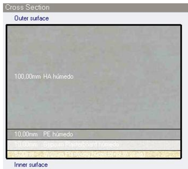
Ilustración 5.2.2.1: Perfil muro exterior.
