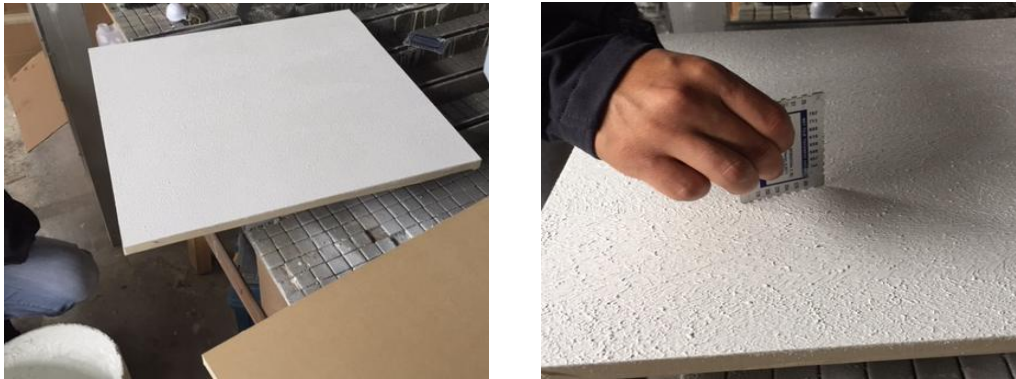
Ilustración 4.2.1.1: Proceso de pintado de probetas y verificación del espesor aplicado.
