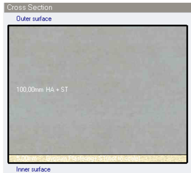
Ilustración 5.2.3.1: Perfil muro exterior.
