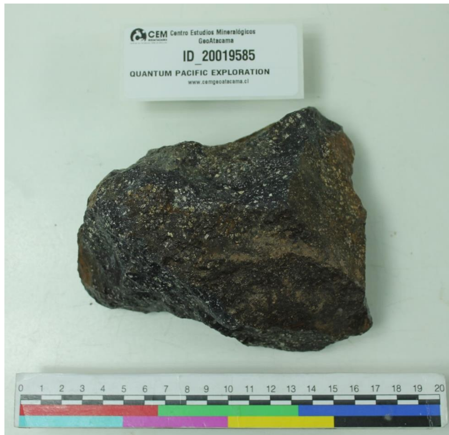
Fotografía 3: Roca del miembro a. de la Formación Punta del Cobre, correspondiente a una toba de lapilli. Muestra 20019585 (Ver anexo B) extraída de las coordenadas UTM 7.058.592N/396.824E. Escala en centímetros.
