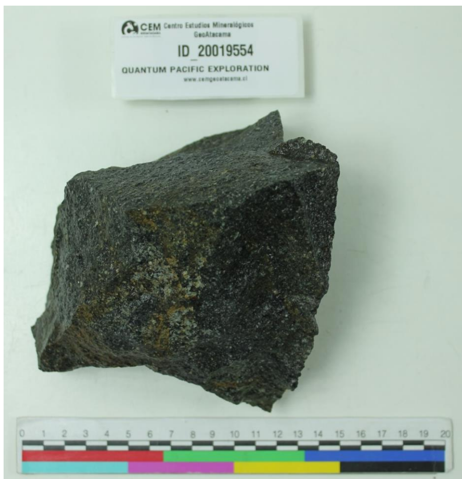
Fotografía 5: Roca de la Unidad Diorítica, correspondiente a la muestra 20019554 (Ver anexo B) extraída de las coordenadas UTM 7.057.464N /396.984E. Escala en centímetros.
