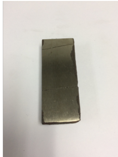
Figura 65. Se observa la muestra placa bimetalica 2 en bruto y en b) se presenta la muestra luego de pasar por la fresa y la rectificadora.
