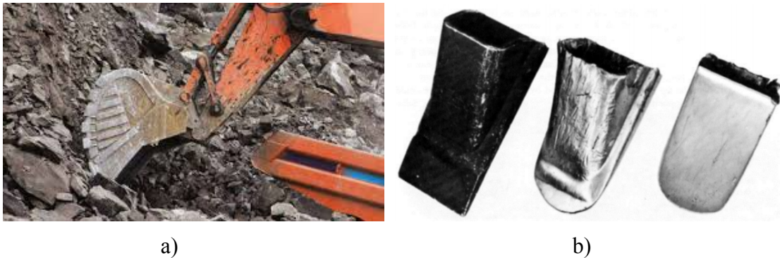
Figura 6. a) Ejemplo de equipos que sufren desgaste en minería por abrasión b) Efecto del desgaste en los dientes de una pala (izquierda: nueva; derecha: desgastada) [11].
