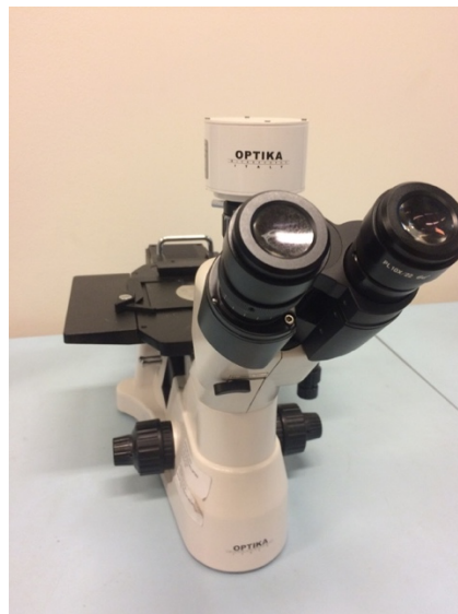
Figura 39. Microscopio óptico marca OPTIKA, con aumento de 5x, 10x, 20x, 50x y 100x.
