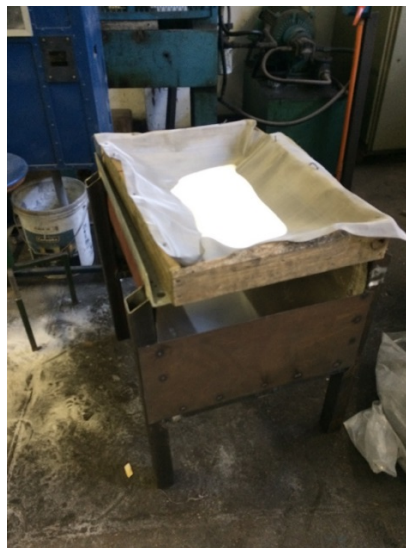
Figura 34. Harnero construido por el estudiante para tamizar la arena.
