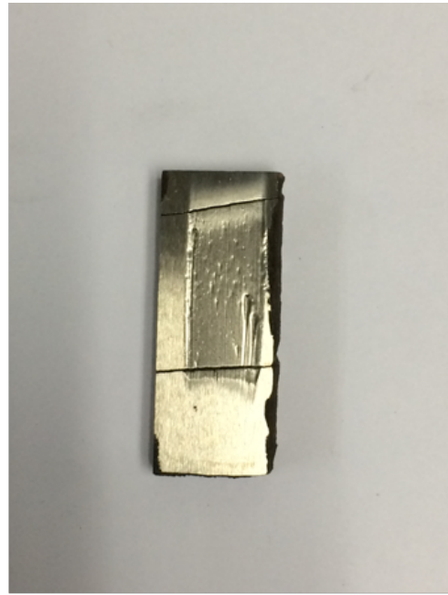
Figura 92. a) Muestra de recubrimiento placa bimetallica 2 antes de ser ensayada y b) la marca resultante del ensayo.
