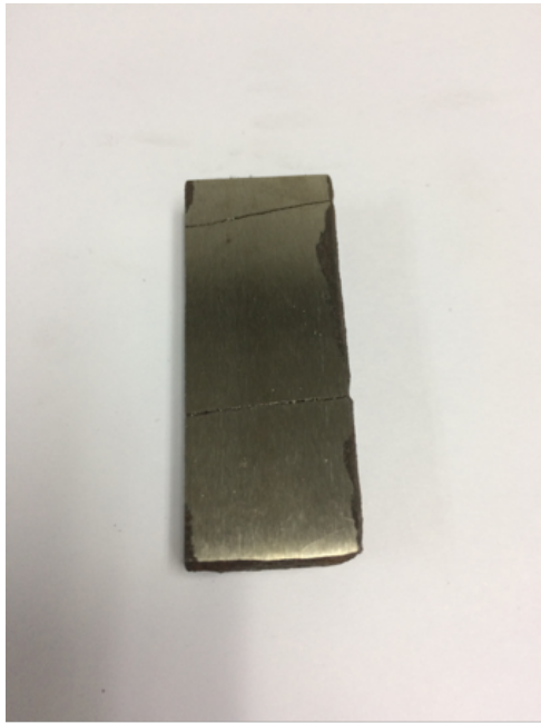
Figura 92. a) Muestra de recubrimiento placa bimetallica 2 antes de ser ensayada y b) la marca resultante del ensayo.
