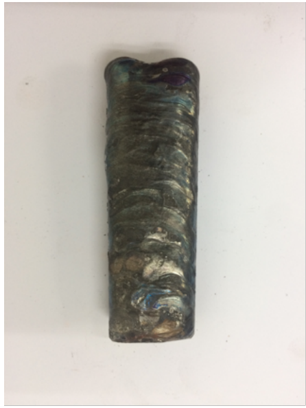
Figura 63. a) Se observa la muestra Overlay 60 en bruto y en b) se presenta la muestra luego de pasar por la fresa y la rectificadora.
