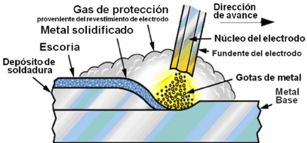
Figura 9. Esquema de soldadura SMAW [13].
