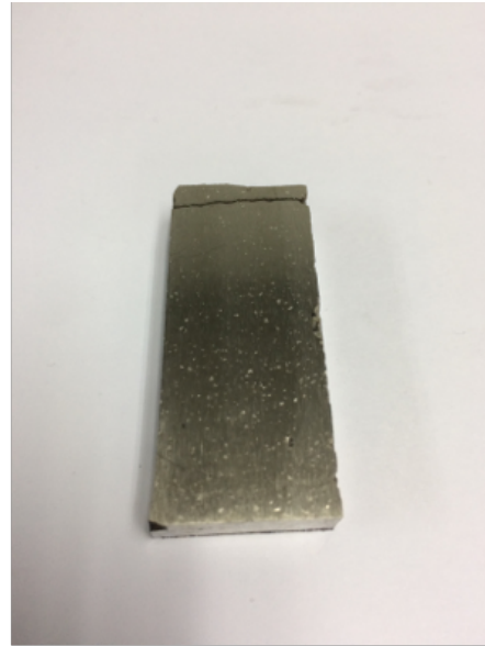
Figura 63. a) Se observa la muestra Overlay 60 en bruto y en b) se presenta la muestra luego de pasar por la fresa y la rectificadora.
