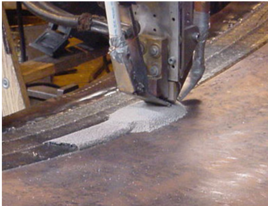
Figura 2. Aplicación de recubrimiento mediante técnica SAW en paredes internas de tuberías [3].
