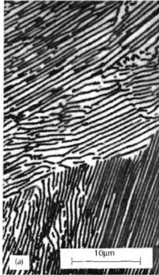
Figura 14. Microestructura típica de un acero perlítico. Las líneas negras corresponden a la fase perlita y la zona blanca corresponde a austenita [16].
