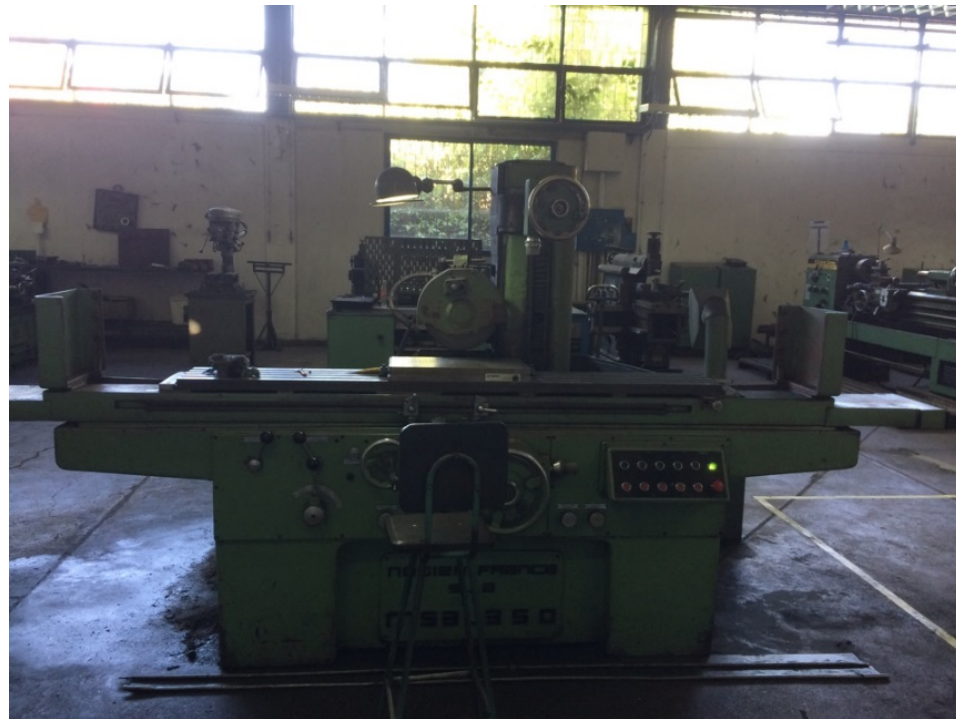
Figura 32. Rectificadora perteneciente al taller mecánico del Departamento de Ingeniería Mecánica de la Universidad de Chile.
