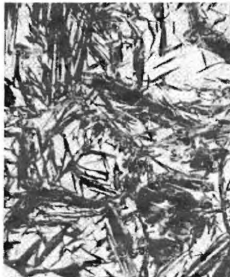
Figura 16. Microestructura típica de un acero martensítico. Los granos en forma de aguja corresponden a la martensita, las zonas blancas corresponden a la fase austenita [16].
