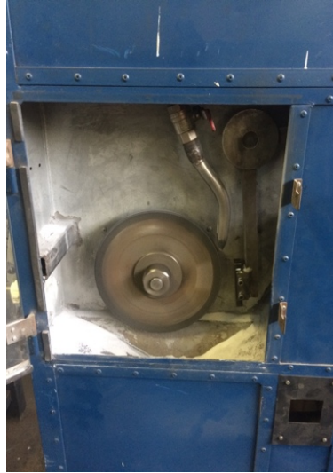
Figura 29. Equipo para realizar ensayo ASTM G-65 disponible en laboratorio del Departamento de Ingeniería Mecánica, Universidad de Chile. (Fuente: Propia)
