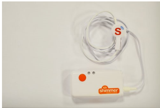
Figura 3.5: Conexión de foto-sensor a la unidad GSR+ de Shimmer.
