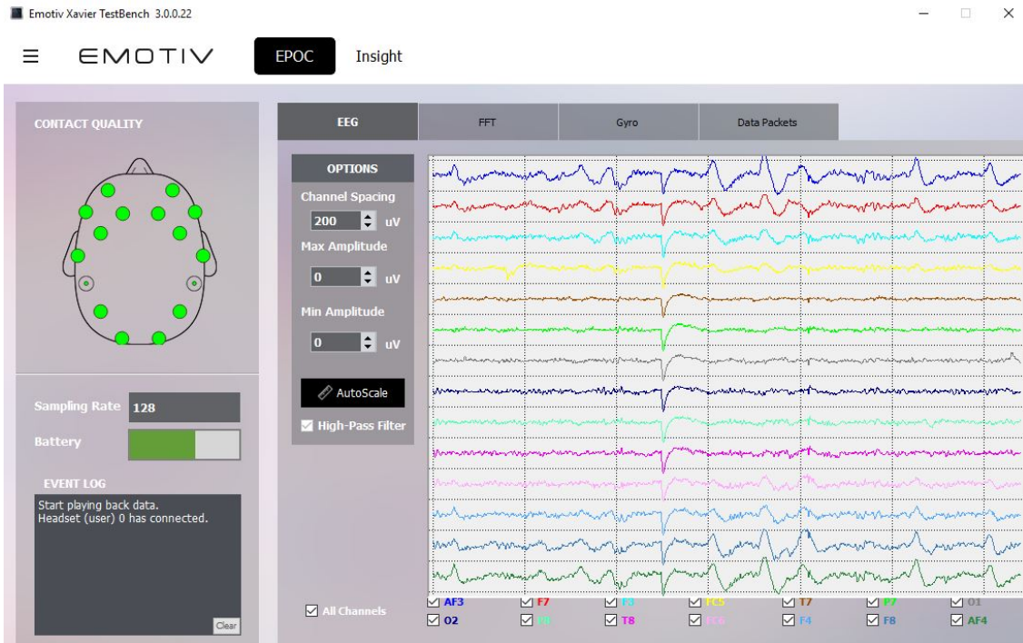
Figura 3.13: Software Xavier Testbench para la verificación de la posición del sensor Emotiv EPOC EEG.
