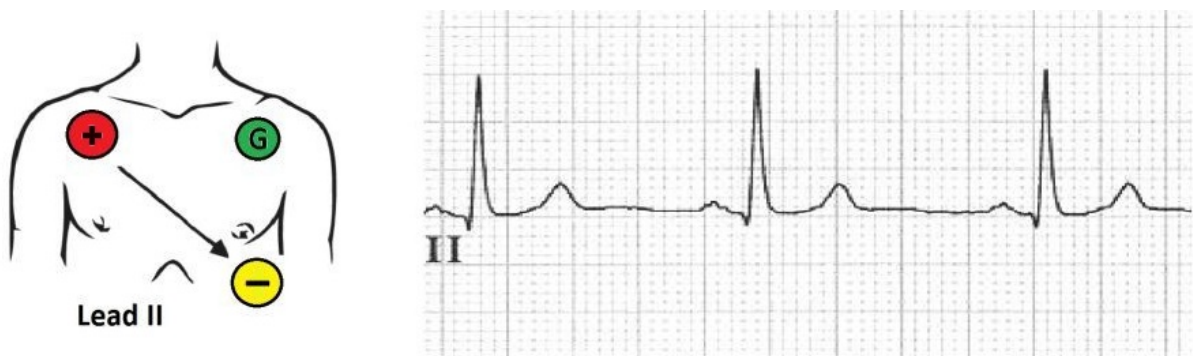
Figura 2.11: Configuración de electrodos ECG Lead II y ejemplo de forma de señal obtenida con esta configuración.
