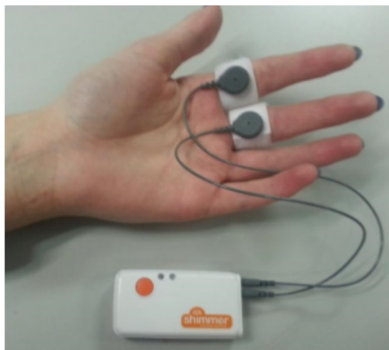
Figura 3.4: Ejemplo de posición de electrodos para el dispositivo GSR+ de Shimmer.
