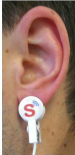
Figura 3.7: Posición correcta en el lóbulo de la oreja del sensor óptico para mediciones de PPG.
