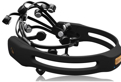
Figura 3.12: Emotiv EPOC EEG. Dispositivo inalámbrico para adquisición de electroencefalograma.
