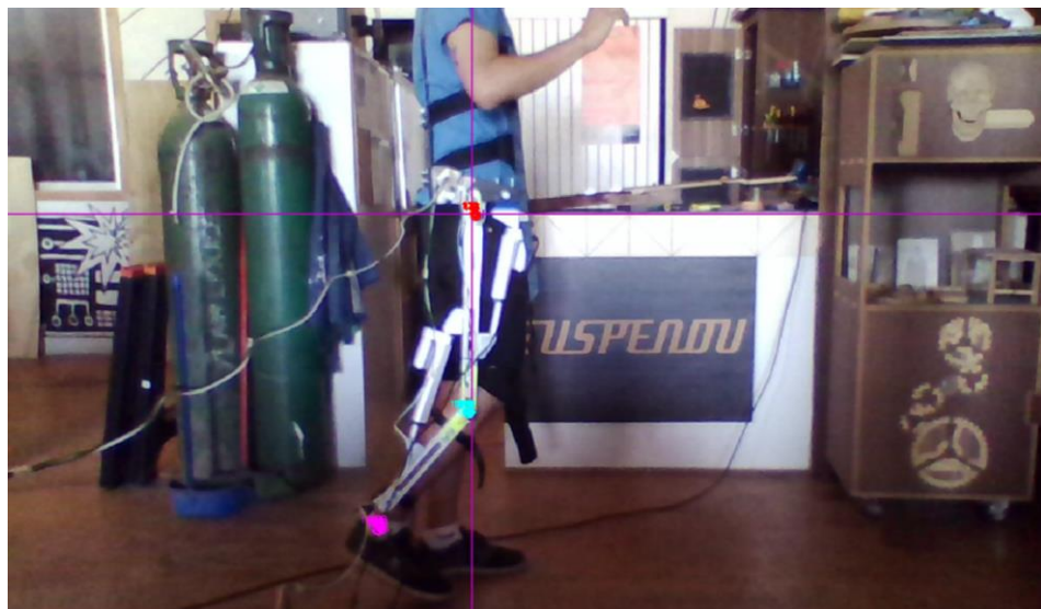
Figura 5-21: Seguimiento realizado con el exoesqueleto para el ciclo correspondiente al ciclo de 0.8 km/h. Fuente: Elaboración propia.
