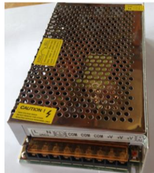
Figura 4-43: Fuente de poder de 24V. Fuente: Elaboración propia.
