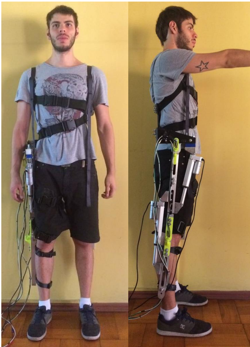
Figura 4-51: Vista frontal y lateral del exoesqueleto con el usuario. Fuente: Elaboración propia.
