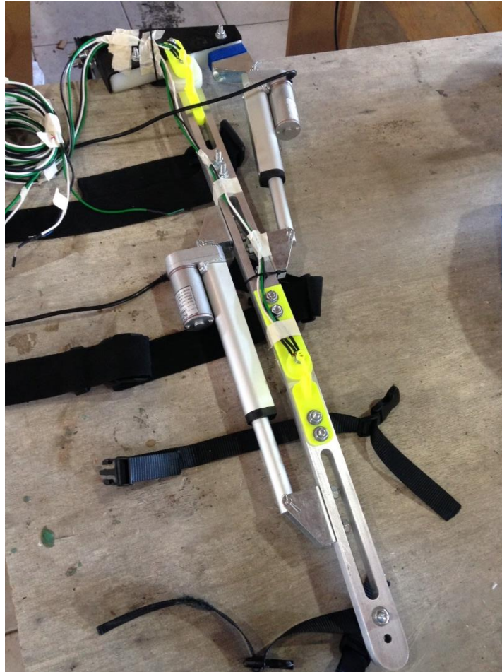
Figura 4-50: Exoesqueleto con el sistema de control a base de potenciómetros instalado. Fuente: Elaboración propia.
