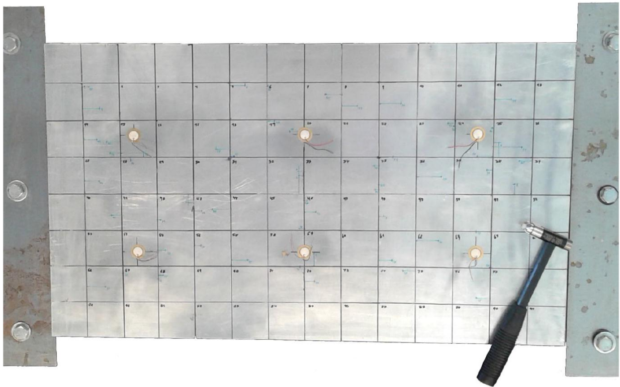
Figura 4.8: Montaje Experimental Placa Compuesta.
