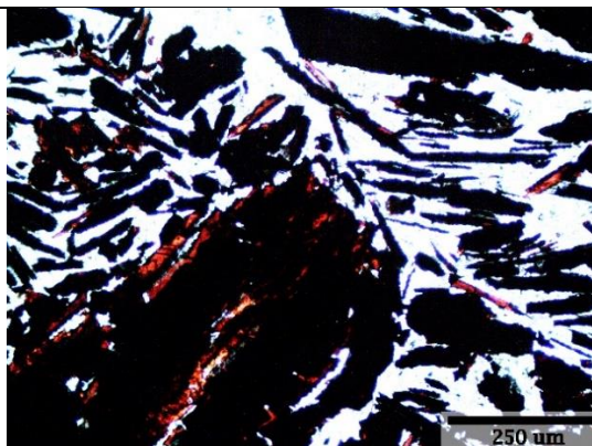
Figura Anexo 37. Fotomicrografía a luz transmitida y a nicoles cruzados, en donde se observa goethita (color rojo) reemplazando bordes de especularita (cristales oscuros).
