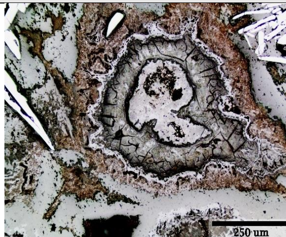
Figura Anexo 66. Misma imagen de la izquierda con luz reflejada. Se distinguen cristales de specularita con colores más brillantes.
