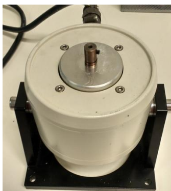
Figura 4-2 Shaker usado para calibración [Elaboración propia]
