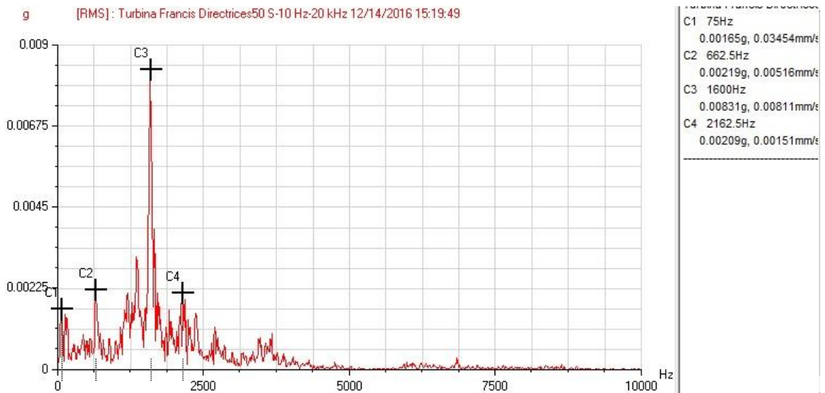
Figura 4-29 Espectro dirección radial con caudal a 90% del nominal [Elaboración propia]
