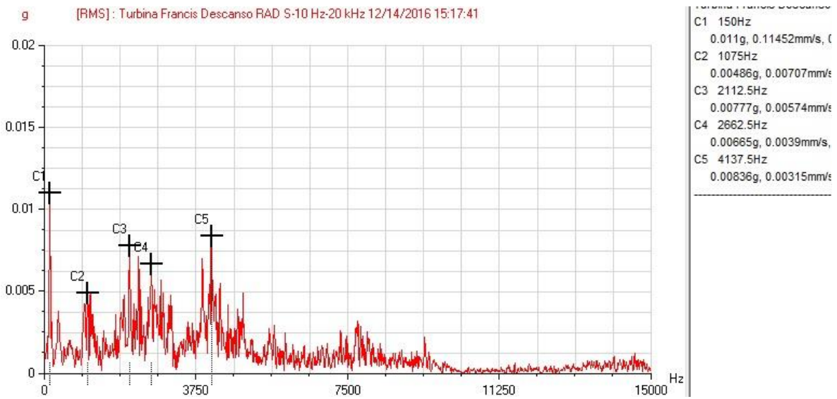
Figura 4-28 Espectro dirección Radial condición óptima de flujo [Elaboración propia, extraído de software]
