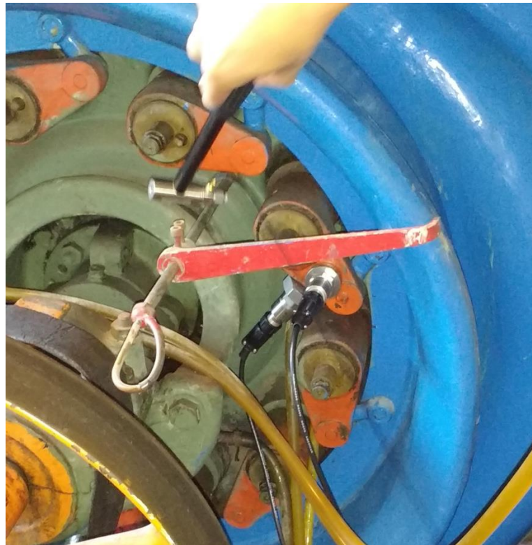
Figura 4-9 Test de impacto en álabe directriz [Elaboración propia]
