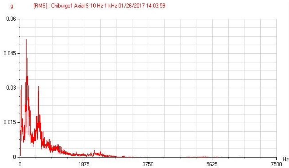
Figura 4-60 FFT Descanso de turbina dirección radial
