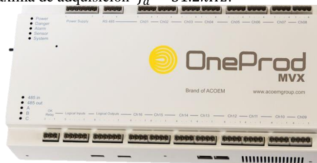
Figura 2-3 Recolector y analizador de datos MVX [Manual del equipo]
