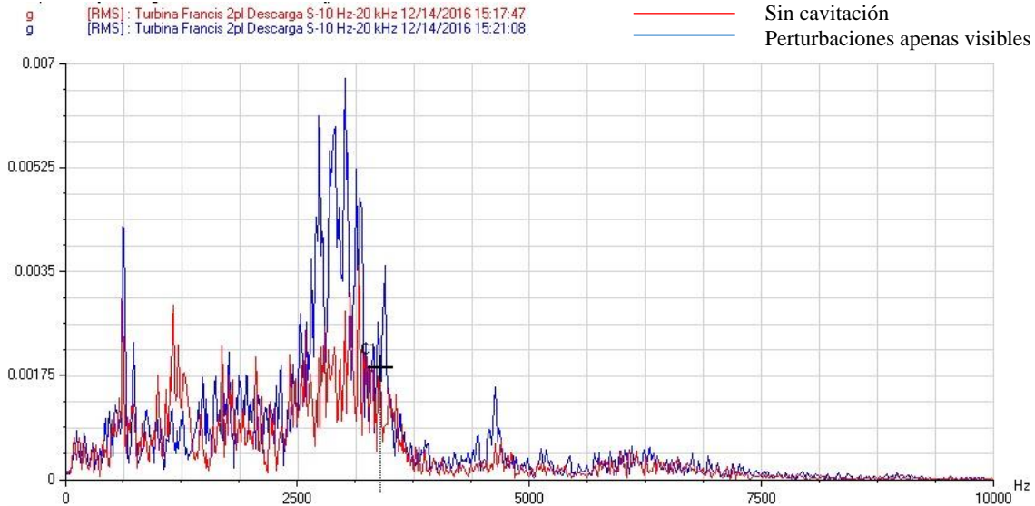
Figura 4-24 Comparación de espectros en la descarga a las 15:17 y 15:21 [Elaboración propia, extraído de software de procesamiento]
