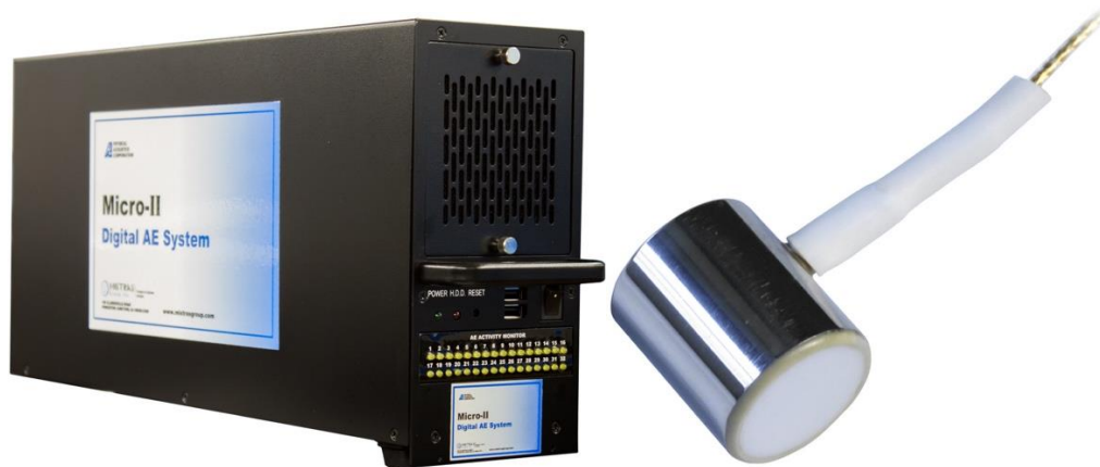
Figura 2-4 Equipo de adquisición de emisiones acústicas con su respectivo sensor.[Manual del equipo]
