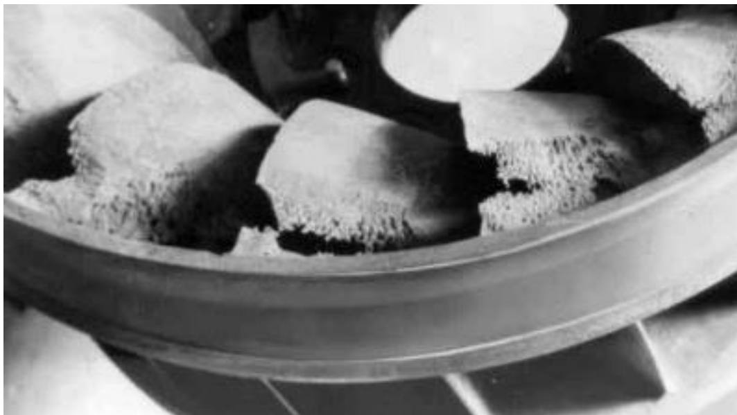
Figura 3-4 Erosión en álabes de un rodete producida por cavitación [10]
