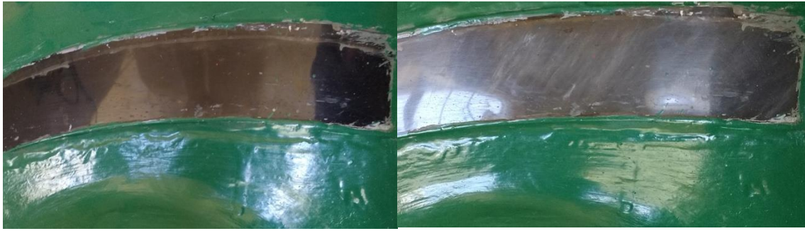
Figura 4-13 Comparación de flujo laminar (izquierda) con flujo con turbulencia y burbujas (derecha) en el visor de la descarga [Elaboración propia]
