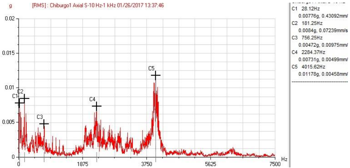
Figura 4-56 FFT descanso combinado dirección axial [Elaboración propia, extraído de software]
