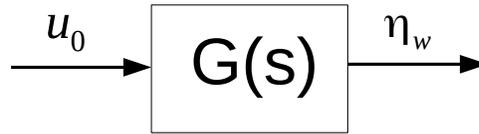
Figura 4.15: Función de transferencia entre la velocidad del pistón y el nivel de agua en la paleta.
