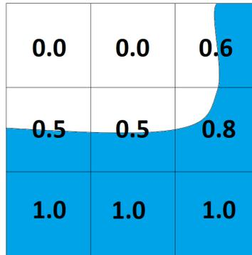
Figura C.1: Esquema del modelo multifásico VOF: malla de un fluido con dos fases.
