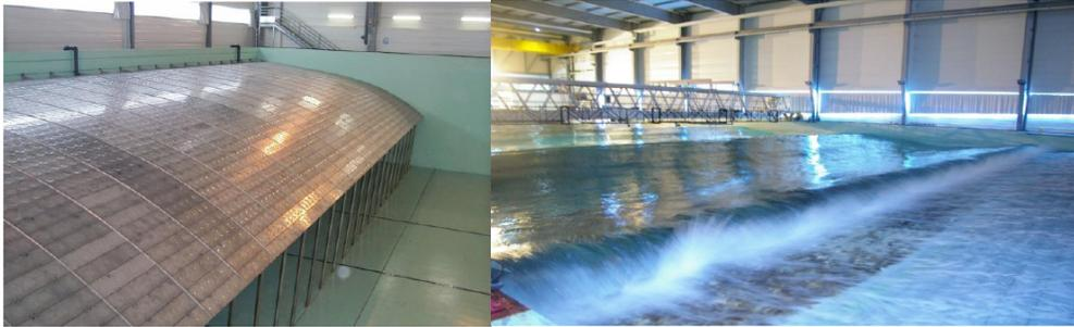
Figura 3.3: Ejemplo de atenuador pasivo.[10]
