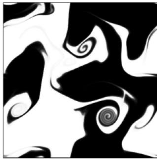
Figura A3. Representación bi-dimensional de la mezcla de dos flujos en condiciones turbulentas. (Extraído de Horn y Rieger). 43
