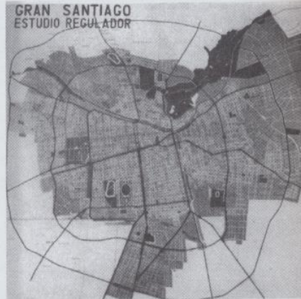
Fig. 2.- "GRAN SANTIAGO ESTUDIO REGULADOR". Proyecto de circunvalaciones formulado por Muñoz Maluschka M., c. 1936, en la Sección de Urbanismo de la D.G.O.P. (anillo exterior en el plano). Fte.: VIOLICH, Francis, 1944. Cities of Latin America. Housing and planning to the south . Reinhold Publishing Corporation, New York, 1944, 241 págs.
