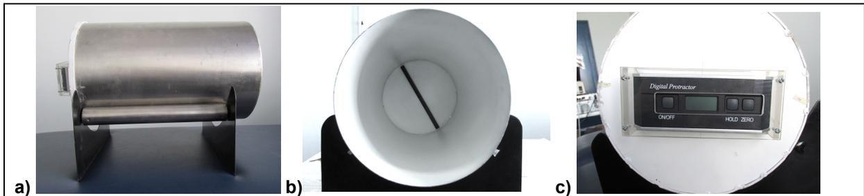
**Figura 1. Instrumento utilizado para la prueba de la SVV.** El balde utilizado, **a)** vista lateral del balde sobre su base, **b)** vista interior donde aparece la línea, **c)** vista exterior del inclinómetro.
