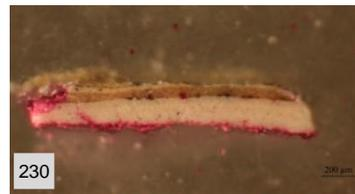
Microfotografía (64x óptico, editada digitalmente) de un corte estratigráfico tras tinción con fucsina ácida
