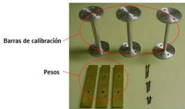
Figura 7. 7.-Barras de calibración.
