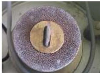
Figura 3. 5.-Elemento piezoeléctrico y *Bender Element*
