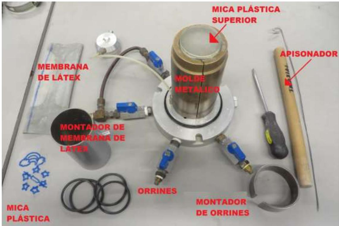
Figura 3. 3.- Materiales de confección de probetas.
