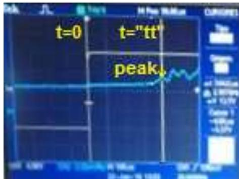
Figura 3. 6.-Pantalla osciloscopio digital. Obtención de tiempo de llegada de onda "tt".
