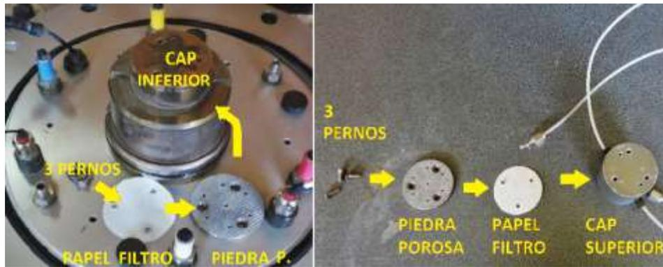
Figura 3. 9.-Forma correcta de poner papel filtro y piedras porosas sobre los cap superior e inferior.
