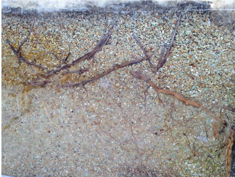
Figura 3.4: Desarrollo del sistema radicular de las plantas en un humedal construido con zeolita como medio de soporte. En los humedales con caliza el crecimiento radicular fue similar.
