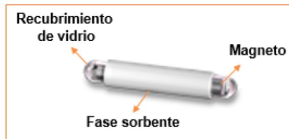
Figura 6. Esquema de SBSE convencional.
