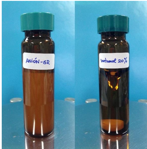
Figura 31. Comparación de turbidez cuando se realiza el “clean up” simultáneamente a la extracción con la fase aniónica en polvo frente a la modalidad post extracción con 1:4 de metanol-agua.
