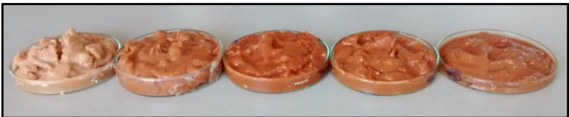
**Figura 2.** Formación de la torta húmeda de silicatos modificados con  $\text{FeCl}_3$ .
