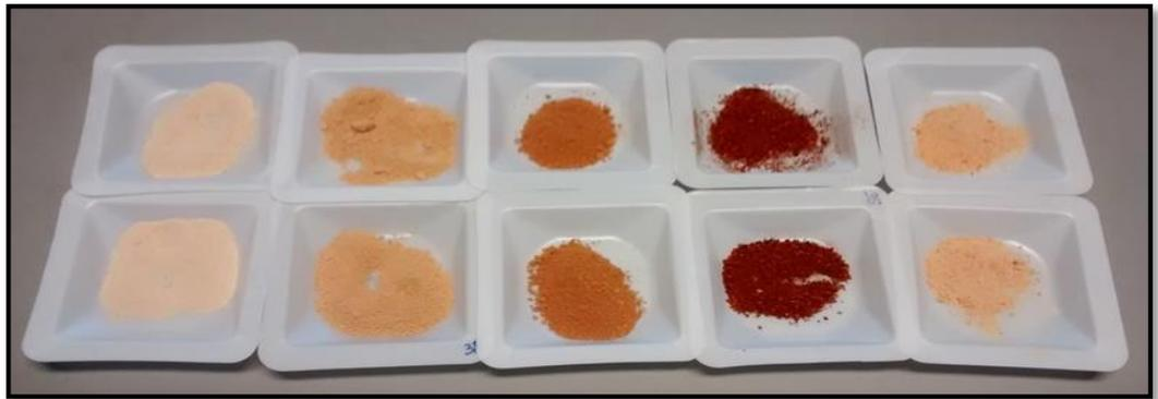
**Figura 3.** Obtención de silicatos modificados con  $\text{FeCl}_3$  al estado de polvo.
