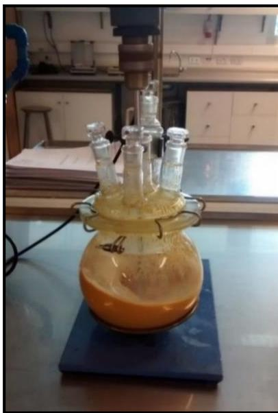
**Figura 1.** Síntesis de los silicatos de calcio modificados con  $\text{FeCl}_3$ .
