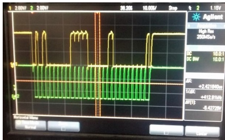
Figura 3.3: Datos de prueba para la interfaz I2C. La señal amarilla corresponde al nodo de datos SDA y la verde al nodo de reloj SCL.
