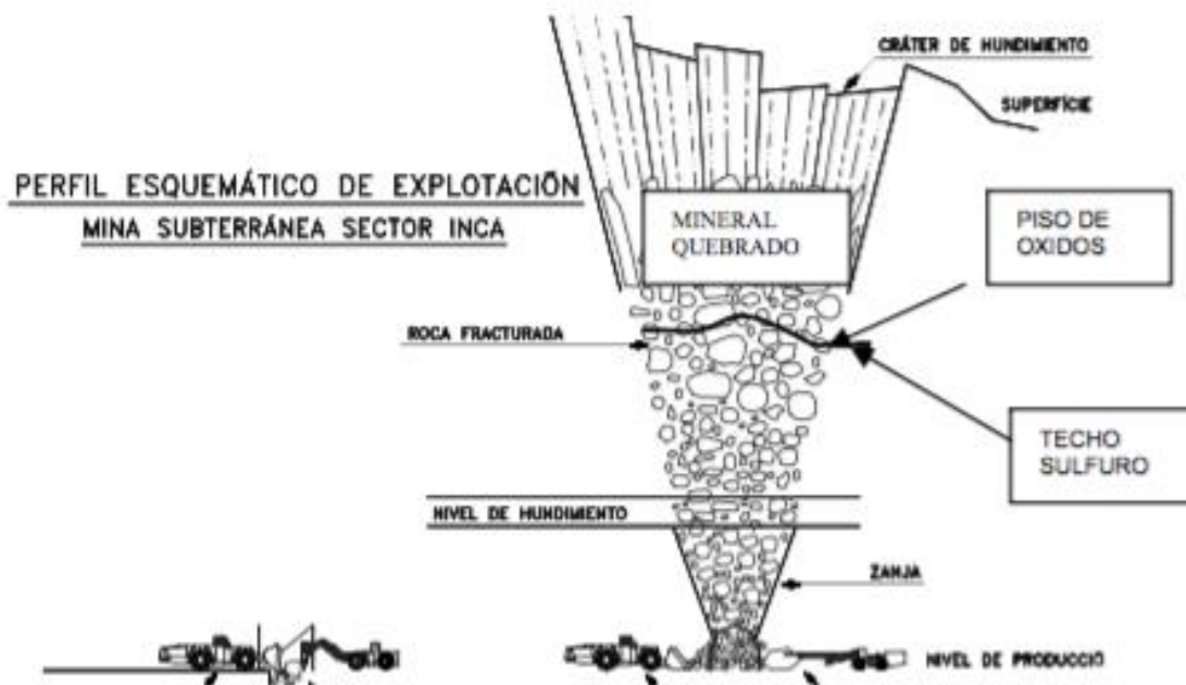
Ilustración 2.1 Perfil esquemático de una explotación subterránea
