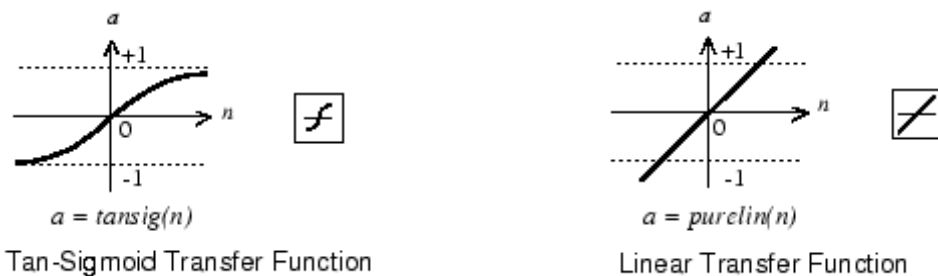
Figura 7: Ejemplos funciones de activación. (Fuente: Universidad de Sevilla [38])
