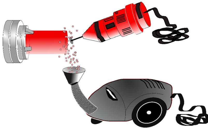
**Figura 3.21.** Método de generación de partículas usando un esmeril Dremel.
