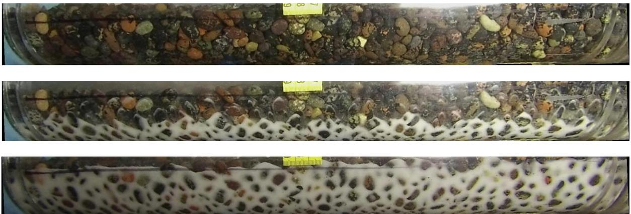
**Figura 4.15.** Perfiles de sedimento reales para los tiempos 0, 7 y 38 minutos respectivamente para el Tramo 1.
