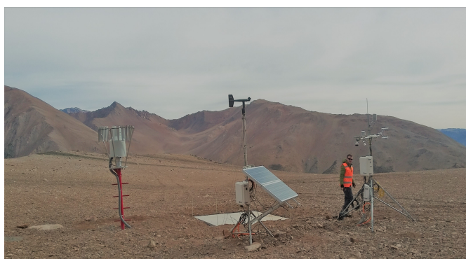
(b) (de izq. a der.) Pluviómetro, snow scale, anemómetro e instrumentos de (a)
