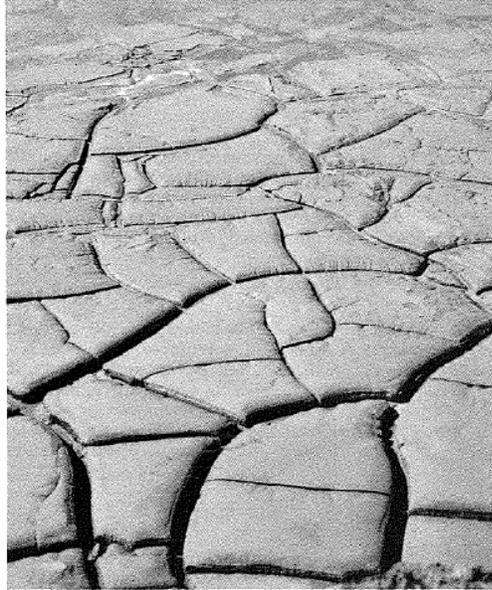
**Figura 8.** Agrietamiento en relaves de mina de carbón en Queensland, Australia. (Morris *et al.* 1991)
