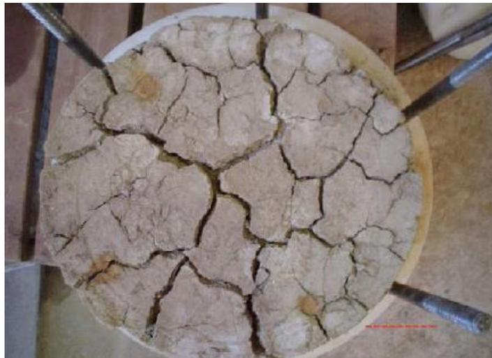
**Figura 7.** Distribución de grietas en muestra de suelo 3, Gorgan (Rayhani *et al.* 2008).
