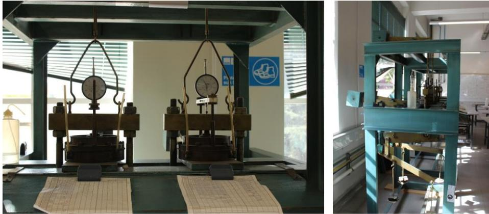
**Figura 34.** Instalación experimental de ensayos de consolidación para caolinita y bentonita.
