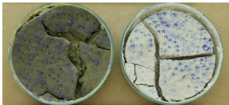
**Figura 15.** Grietas en muestras de bentonita (izquierda) y caolinita (derecha).
