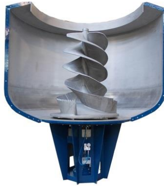
Figura 2: Pulper de uso industrial utilizado en la fabricación de papel.
